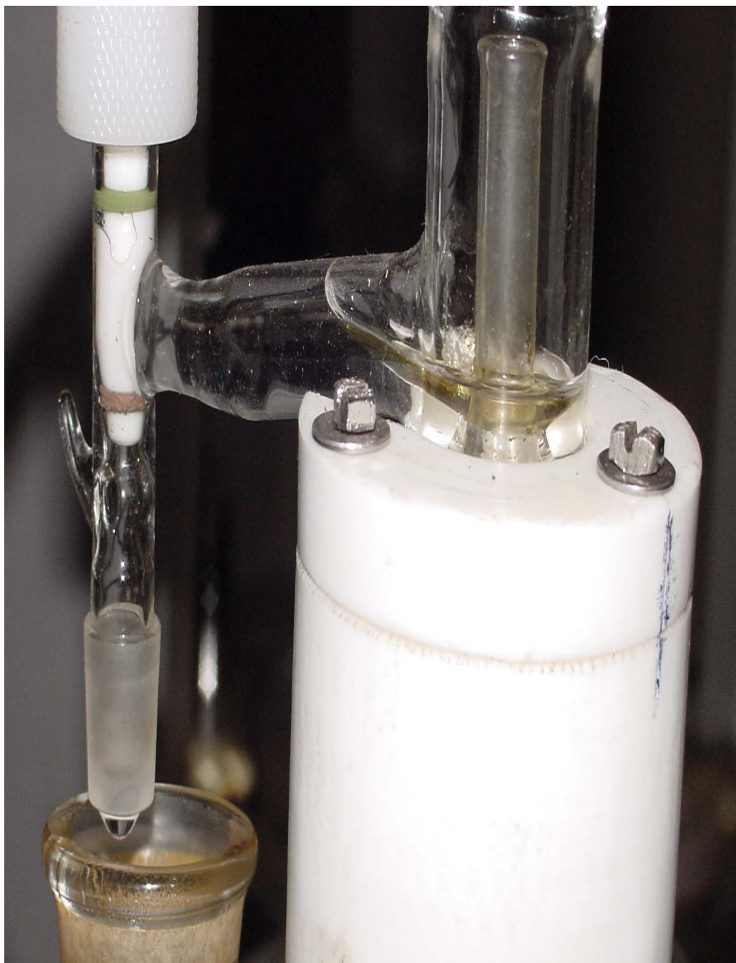
Figura 4.13 – Reservatório do óleo e válvula.
