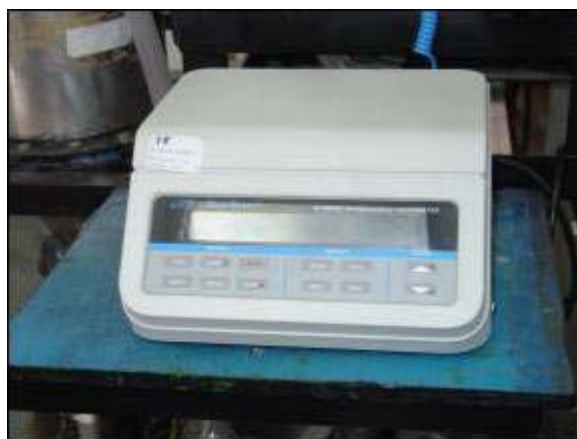
Figura 3.3- Módulo digital utilizado para a leitura das temperaturas.
