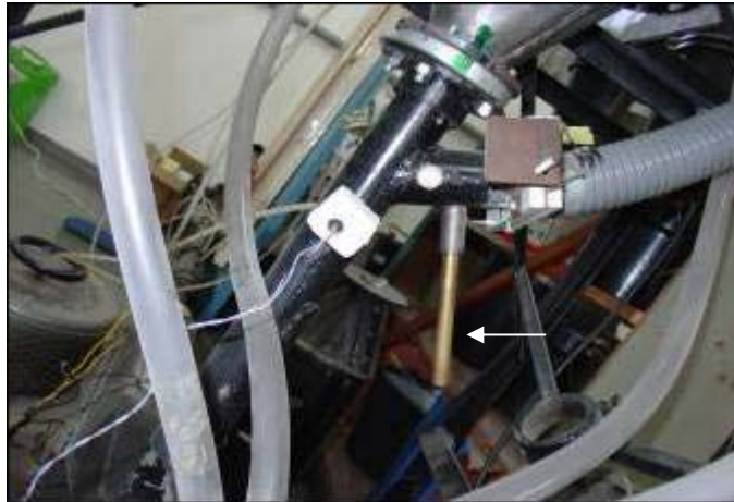
Figura 3.5- Tubo coletor instalado na seção de alimentação das partículas.
