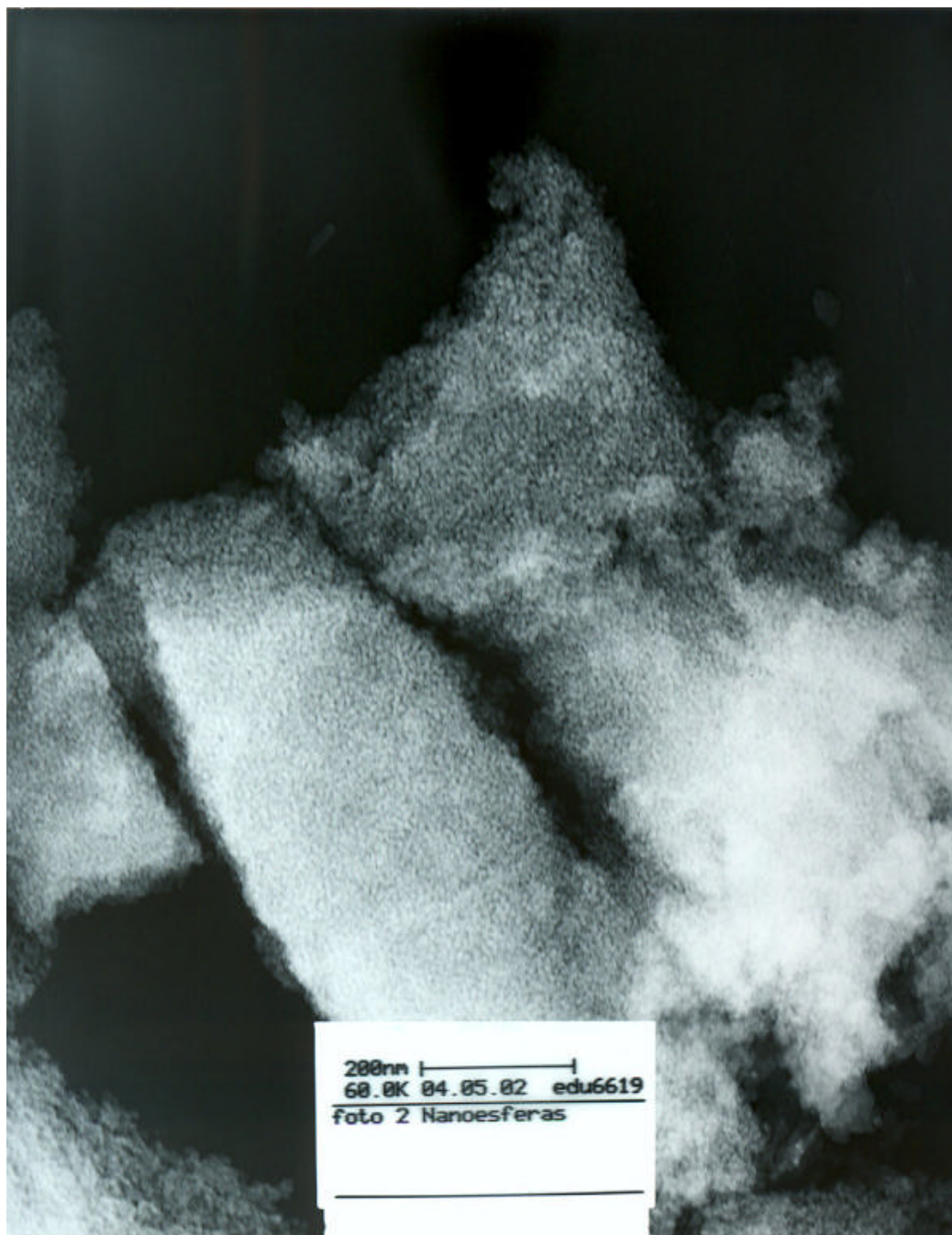
Figura A.2: Microscopia eletrônica de transmissão da amostra (0,1/2,0)60, com diâmetro de partícula de 50 nm (imagem de campo escuro).
