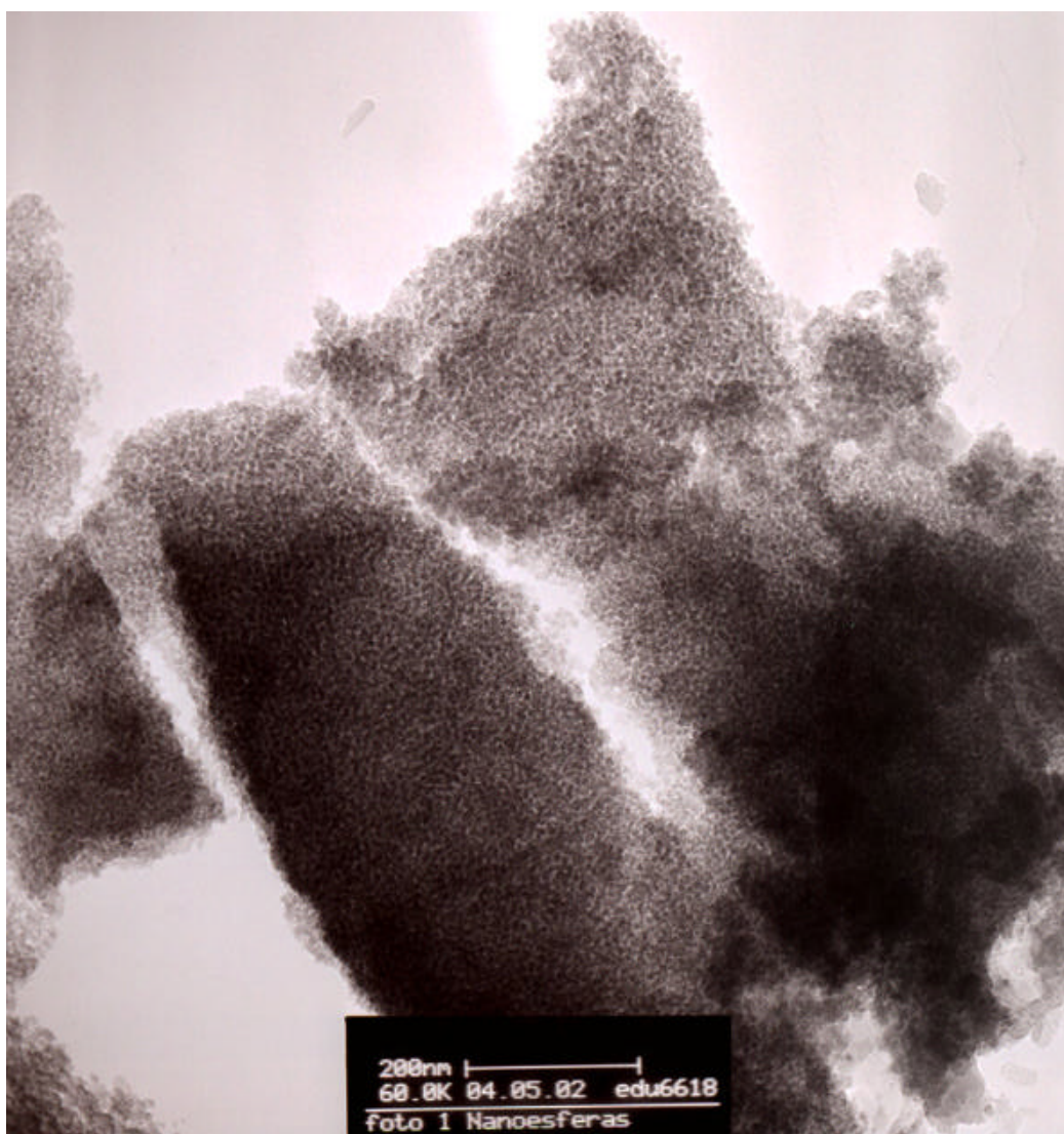
Figura A.1: Microscopia eletrônica de transmissão da amostra (0,1/2,0)_{60} , com diâmetro de partícula de 50 nm (imagem de campo claro).
