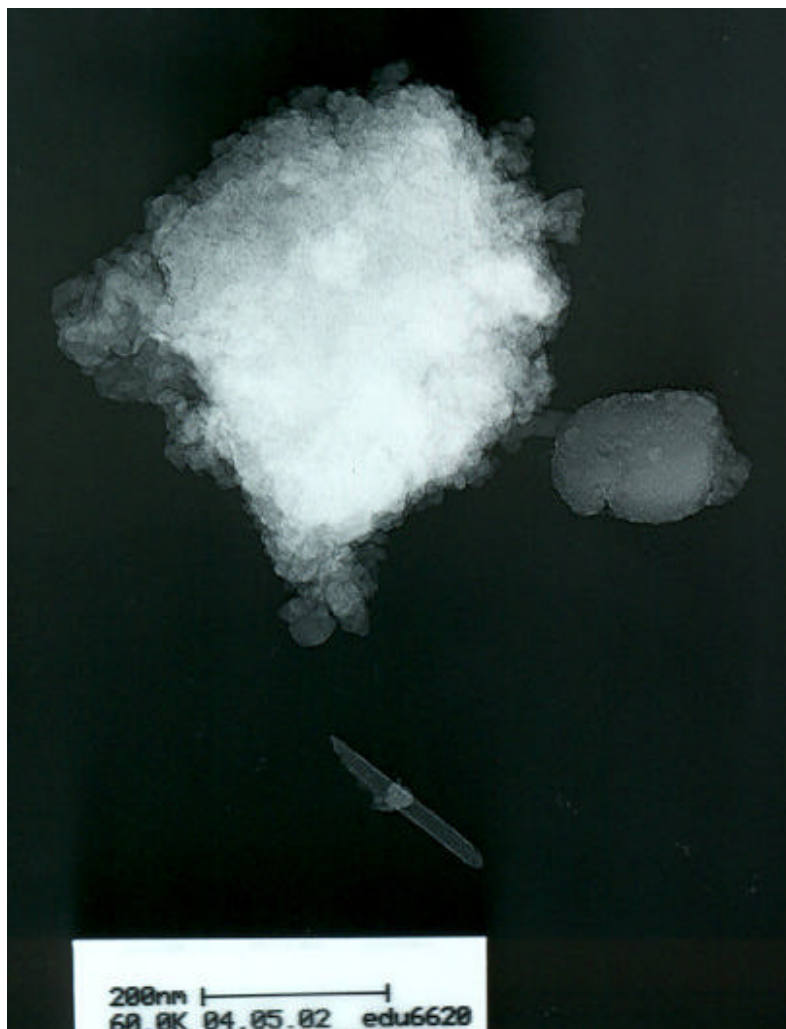
Figura A.4: Microscopia eletrônica de transmissão da amostra (0,1/2,0)60, com diâmetro de partícula de 50 nm (imagem de campo claro).
