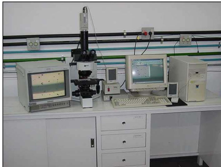
Figura 3.2 – Equipamentos ligados em série para a aquisição e análise de imagens.
