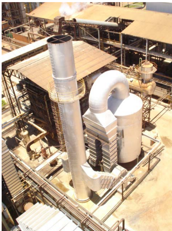
Figura 25 – Foto de uma plataforma segura para amostragem de Gases
