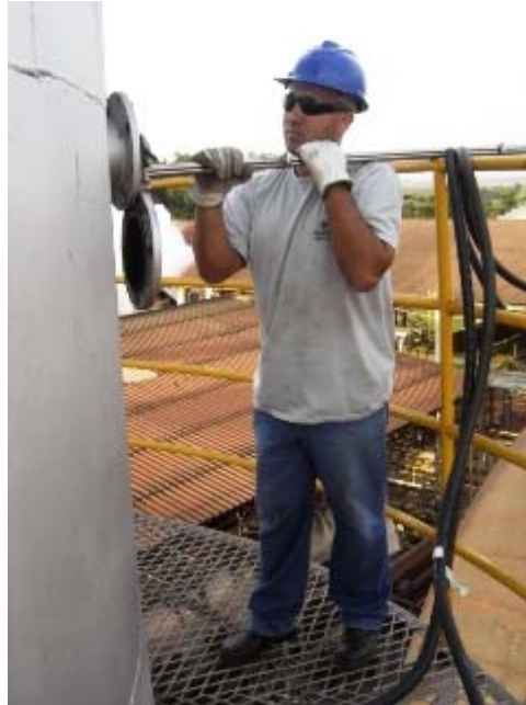
Figura 27 - Posicionamento da Sonda numa Chaminé.
