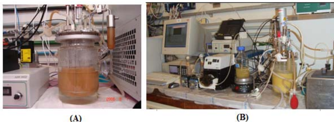
Figura 3.1 - (A) Reator Aplikon com capacidade para 2 L. (B) Sistema de aquisição de dados.
