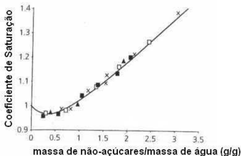
Figura 2. 26: Curva do coeficiente de saturação em função da quantidade de não-açúcares (POEL et al., 1998)
