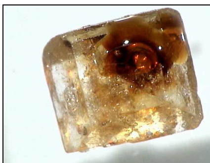
Figura 2. 27: Inclusão de licor-mãe em um cristal de sacarose de cana (MANTELATTO, 2005)
