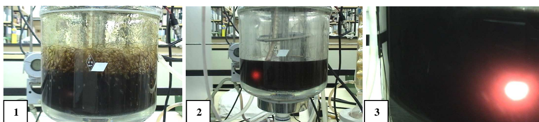
Figura 3. 6: Parte 1 - Concentração da solução; Parte 2 – Aquecimento da solução acima da temperatura de saturação; Parte 3 – Solução sem núcleos presentes.
