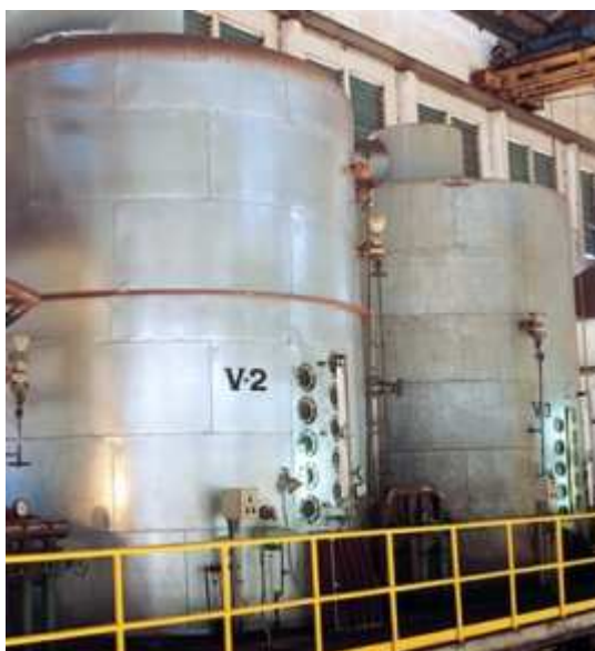
Figura 2. 7: Ilustração de um cozedor
