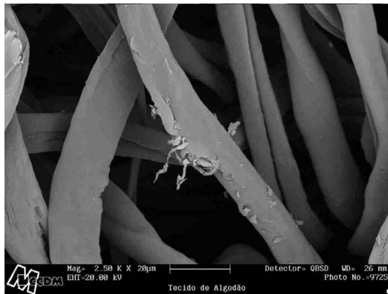
Figura 4.3 – Fibras do tecido de algodão, micrografia obtida no MEV do CCDM, com aumento de 2.500 vezes
