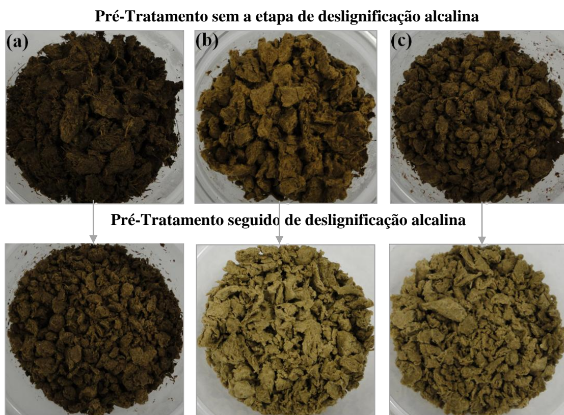
Figura 4.9 – Fotos do bagaço de cana após pré-tratamento organossolve a 190°C/90min variando a concentração de etanol em solução: (a) 30%; (b) 50% e (c) 70% e bagaço de cana pré-tratado seguido de deslignificação com NaOH (1% m/v) 100°C/1h.
