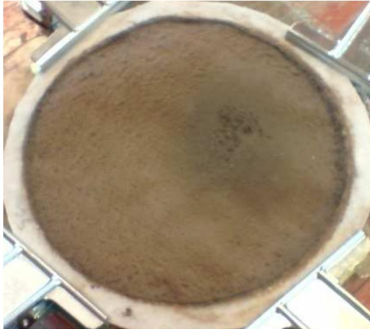
Figura 3.7 – Torta de filtração de rocha fosfática em feltro de poliéster após o pré-endurecimento.
