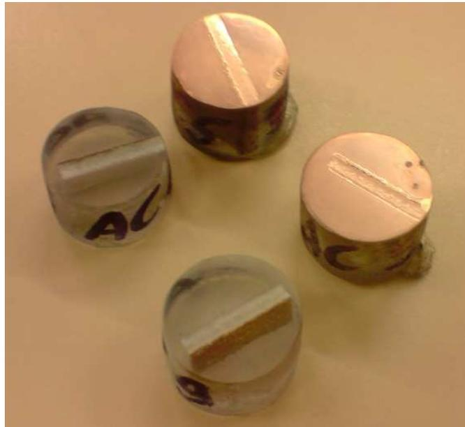
Figura 3.8 – Foto de duas tortas embutidas e polidas (esquerda) e de duas tortas após tratamento para visualização no MEV (direita).
