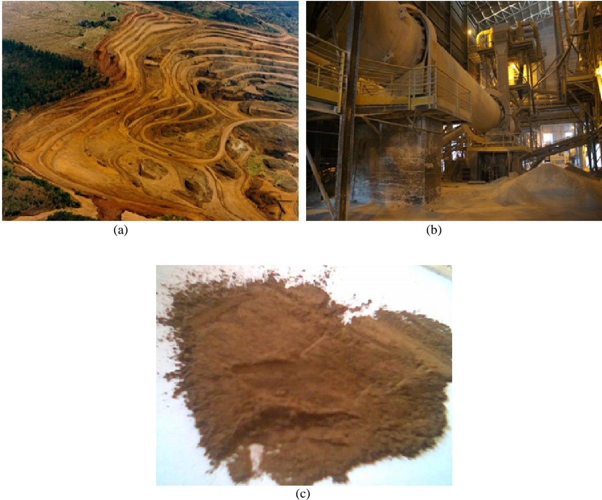
Figura 2.4 – (a) Mina de extração, (b) usina de beneficiamento da rocha fosfática e (c) o produto já beneficiado. Fonte (a): Codemig ([www.codemig.com.br](http://www.codemig.com.br), acesso em 07/12/2009); (b): Serrana Fertilizantes ([www.serrana.com.br](http://www.serrana.com.br), acesso em 07/12/2009) e (c): MF Rural ([www.mfrural.com.br](http://www.mfrural.com.br), acesso em 08/12/2009).
