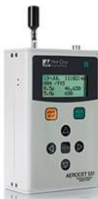
Figura 10. Amostrador de partículas Aerocet 531 utilizado na avaliação de material particulado.
