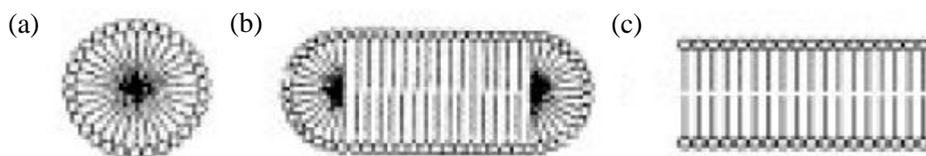
Figura 3.12. Representação esquemática das geometrias relacionadas com o fator de empacotamento, g : (a) g = 0,33 ; (b) g = 0,5 e (c) g = 1 (LINDÉN et al. , 1998).
