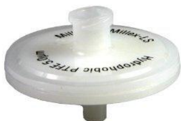
Figura 4.12. (a) Imagem do filtro Milex (0,45 µm) e (b) Sistema de filtração contendo o filtro Milex acoplado à seringa.
