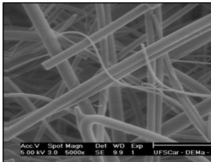
Figura 11 - Imagem da superfície do meio filtrante de Microfibras de Quartzo obtida em MEV-FEG
