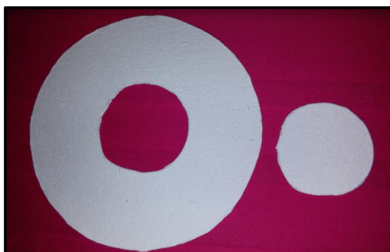
Figura 15 - Amostra do filtro de Quartzo com área de 40,7cm 2 à esquerda e à direita amostra cortada do centro para utilizar na determinação da permeabilidade com a área de 5,3 cm 2
