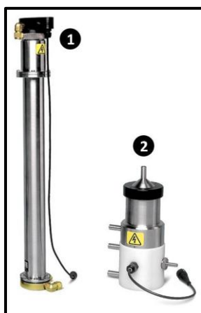
Figura 35 - Analisador de Mobilidade Diferencial: (1) Long-DMA e (2) Nano-DMA
