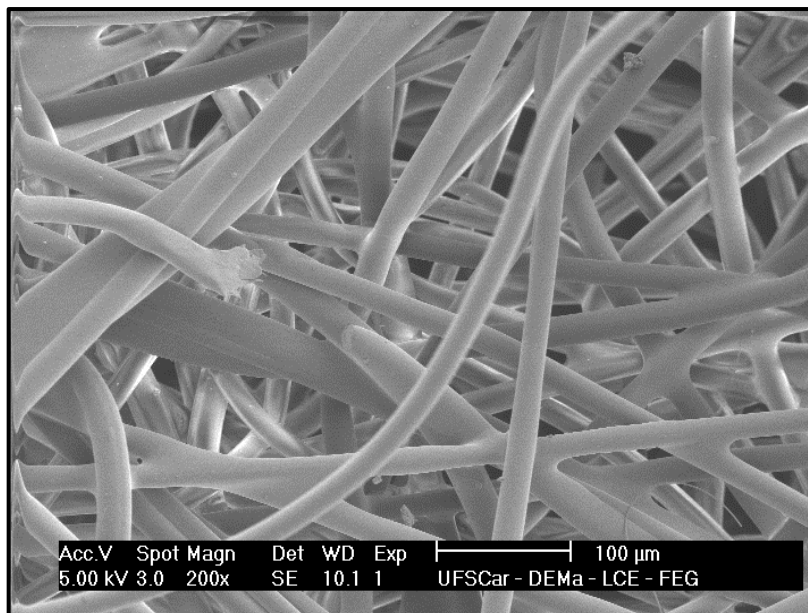
Figura 12 - Imagem da superfície do meio filtrante de poliéster obtida em MEV-FEG
