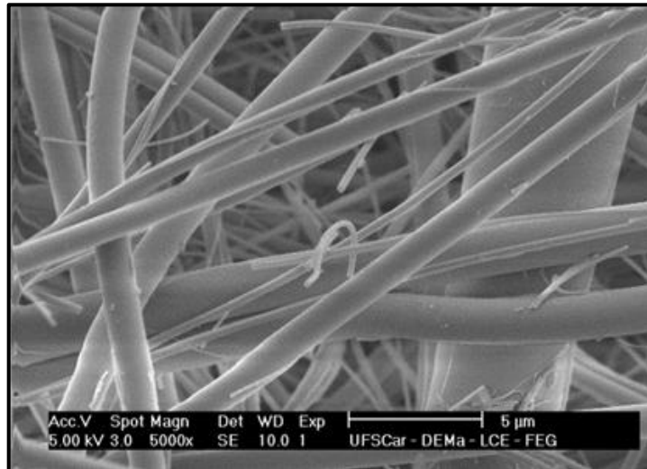
Figura 10 - Imagem da superfície do meio filtrante de vidro obtida em MEV-FEG
