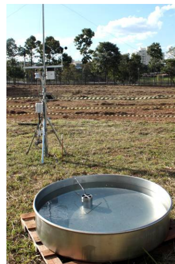
Figura 71 – Tanque Classe A e sensor de Nível d'água
