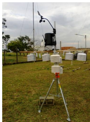
Figura 89 – Sensores HOBO U-23 e Estação Meteorológica Davis
