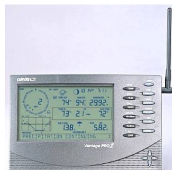
Figura 87 – Módulo controlador com datalogger
