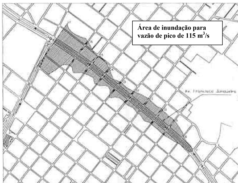
Figura 11c – Áreas de Inundação no córrego do Retiro Saudoso- Ribeirão Preto-SP, para a vazão de pico de 115 \text{ m}^3/\text{s} . Fonte: Pires, pp107 (1997).
