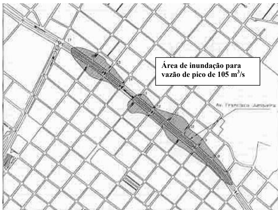
Figura 11b – Áreas de Inundação no córrego do Retiro Saudoso- Ribeirão Preto-SP, para a vazão de pico de 105 m 3 /s. Fonte: Pires, pp 104 (1997).
