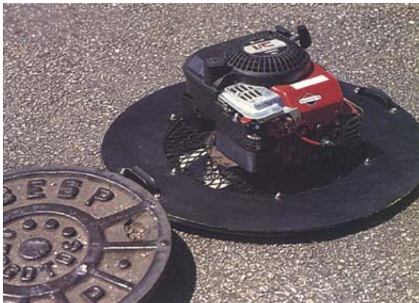
Figura 5.1 – Equipamento para o teste de fumaça
