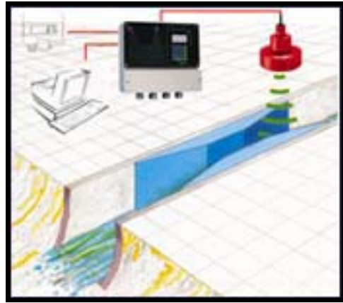
Figura 3. 7 - Esquema de instalação do medidor ultra-sônico de vazão
