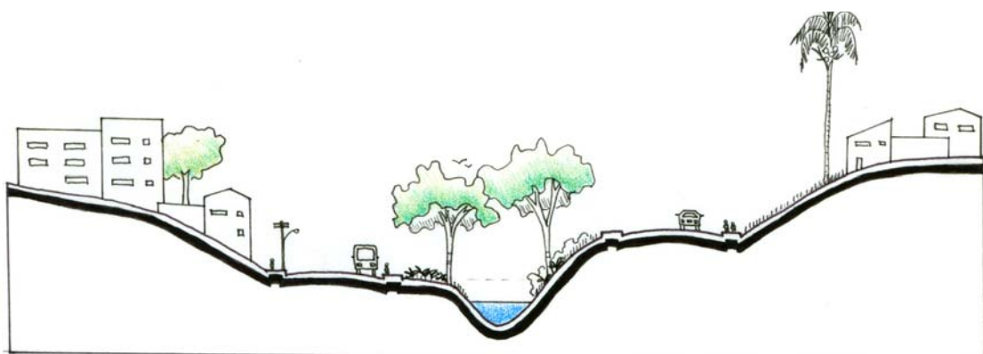
Figura 26: Ocupação de fundo de vale por avenidas marginais e loteamentos ( curso d'água não modificado ).
