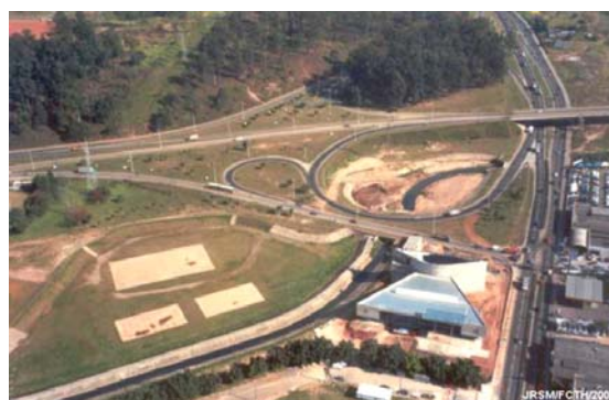
Foto 29: Ocupação de fundo de vale por áreas de retenção de águas pluviais, “piscinão” ( curso d’água canalizado ). Mauá, área metropolitana de São Paulo-SP
