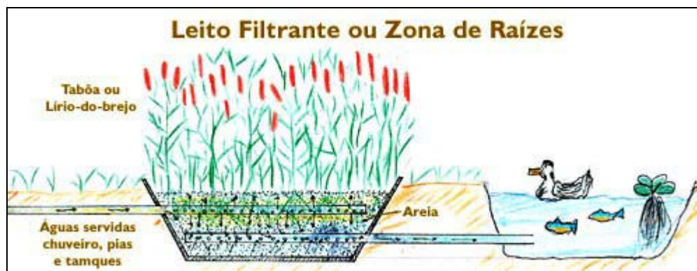
Figura 77: Esquema do Leito Filtrante elaborado por Edson Hiroshi SÉO (fonte: CLAREANDO, 2005).
