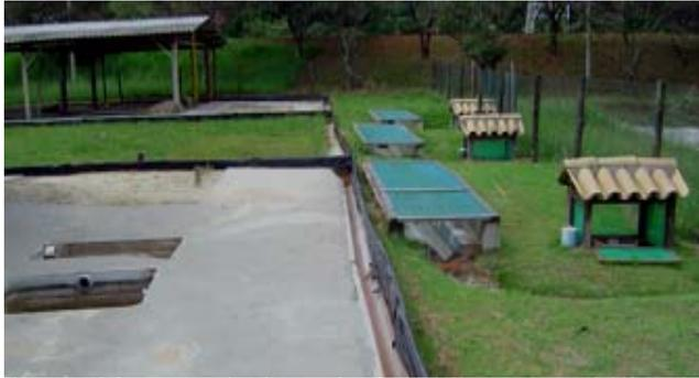
Figura 30 – Acréscimo de áreas impermeabilizadas nos lotes (primeiro plano e ao fundo), vendo-se as calhas, vertedores e sensores de vazão. Acervo do autor.
