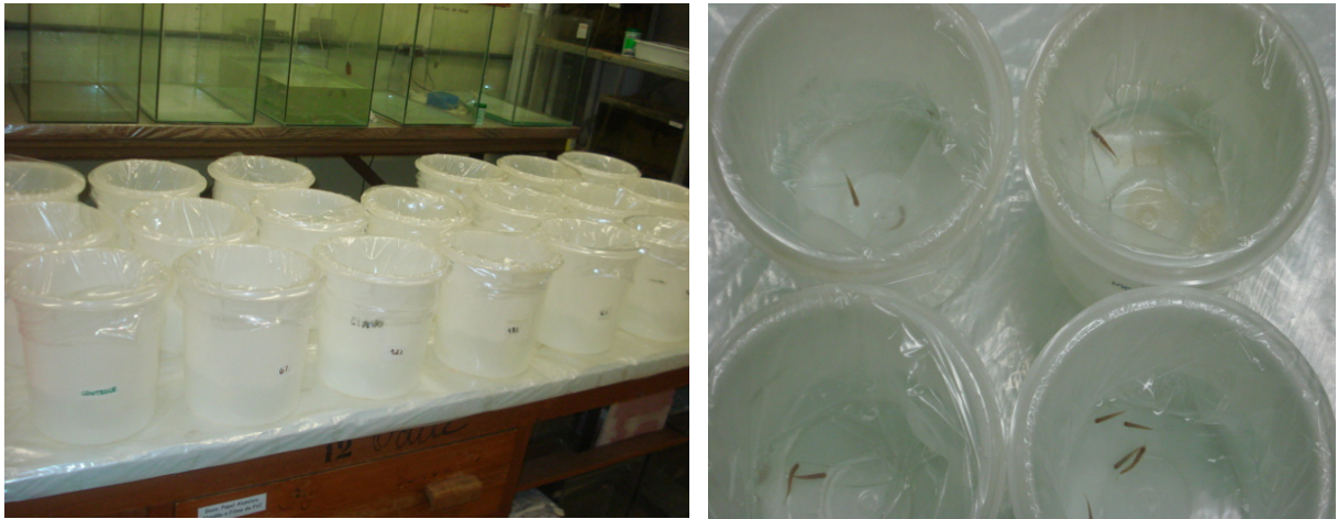
Figura 5 – Vista dos recipientes-testes utilizados nos ensaios de toxicidade aguda para o peixe Danio rerio com efluentes de laboratórios químicos. (Foto: M. S. Georgetti).
