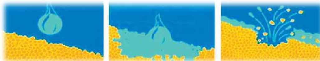
Figura 8- Esquema da desagregação do solo pelo impacto da gota de chuva ou da água de irrigação
