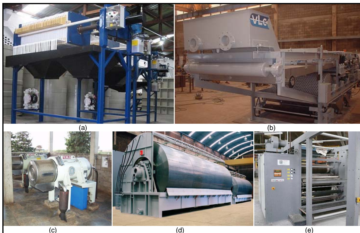
Figura 3.7 – Sistemas mecânicos para desidratação de lodo: (a) filtro-prensa em operação – São Bernardo do Campo (SP); (b) prensa desidratadora, VLC Indústria e Comércio Ltda. 4 ; (c) Centrífuga, ETE de Araçatuba (SP) – DAEA 5 ; (d) filtro à vácuo, MAUSA S/A 6 ; (e) contipress, M-TEC CONTIPRESS 7 .
