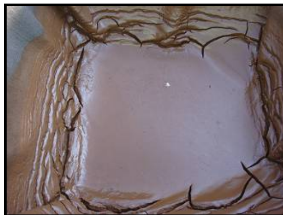
Figura 5.19 – Ensaio 01 - Um dia após do despejo de lodo no protótipo com cobertura a 0,20 m de altura.
