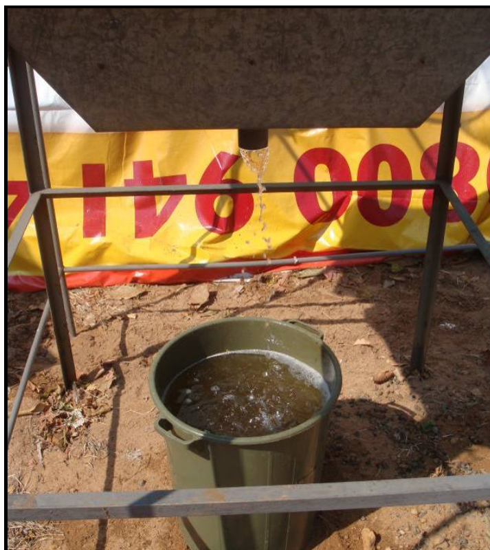
Figura 4.14 – Drenagem inicial do lodo bruto de decantador coletado.
