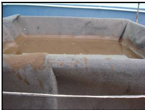
Figura 5.18 – Ensaio 01 - Despejo de lodo no protótipo de leito de drenagem.
