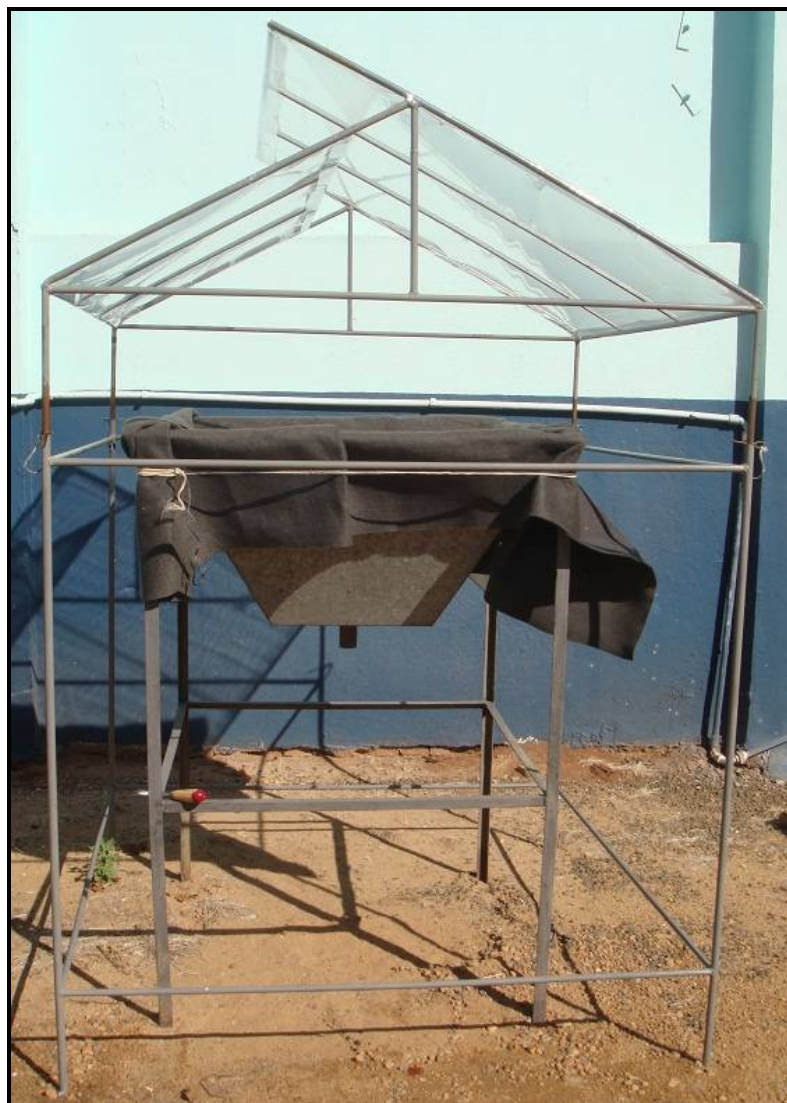
Figura 4.10 – Protótipo de leito de drenagem com cobertura plástica e ajuste de altura utilizado nos ensaios.
