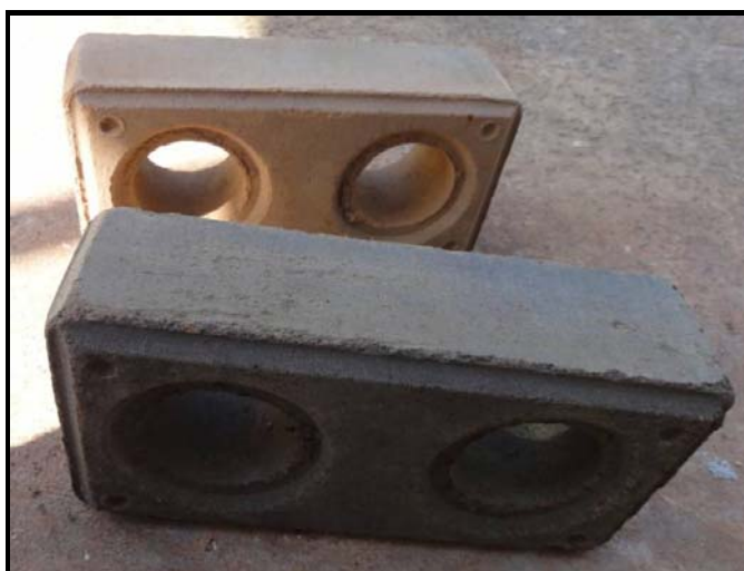
Figura 3.32 – Frente: bloco cerâmico sem adição de lodo; fundo: bloco cerâmico com adição de lodo da ETA de Nova Odessa-SP.
