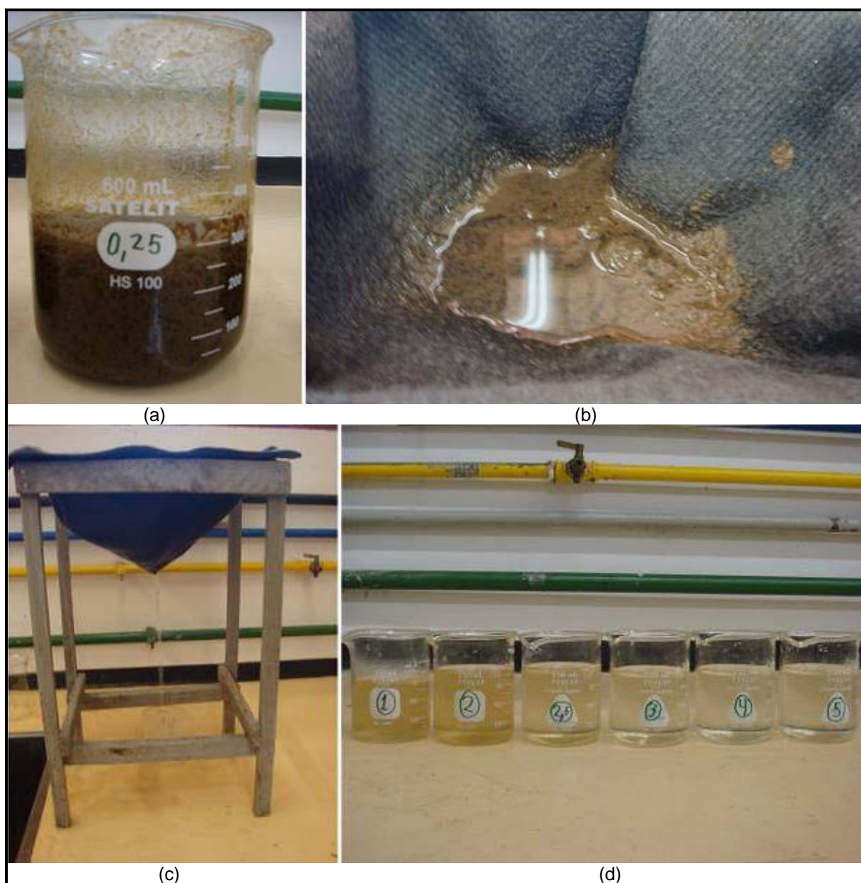
Figura 4.5 – Etapas de ensaio com polímero catiônico: (a) preparação de solução e mistura com lodo bruto; (b) despejo no minileito de drenagem; (c) drenagem da água livre; (d) amostras de água drenada.
