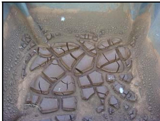
Figura 5.21 – Ensaio 01 - Lodo desaguado no leito de drenagem sem cobertura, sete dias após o despejo inicial.
