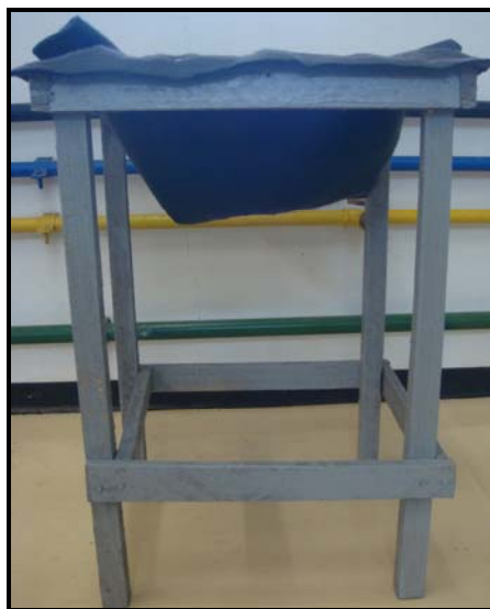
Figura 4.2 – Minileito de drenagem.
