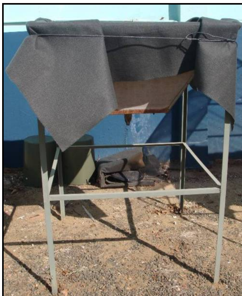
Figura 4.8 – Protótipo de leito de drenagem utilizado nos ensaios.
