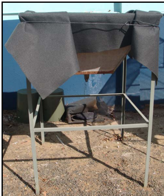
Figura 4.1 – Protótipo de leito de drenagem.
