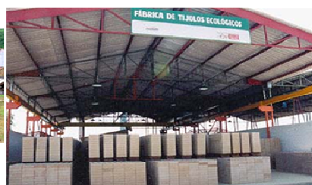
HABITARE-MCT-FINEP Aprova Tecnologia de Solo Cimento: Tijolo Ecológico Fábrica em Volta Redonda
