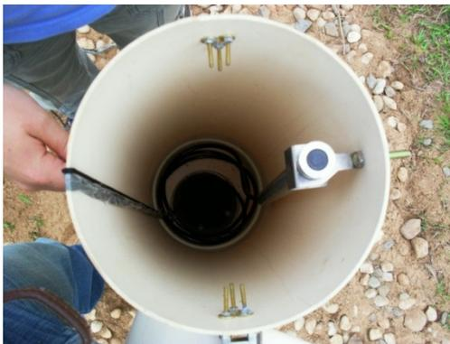
**Imagem 5.27.** Inserção do material de coleta dentro do poço de monitoramento, mantendo a posição do cabo do sensor de nível também instalado no poço
