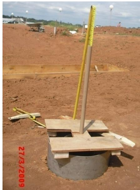
**Figura A.2.** Infiltrômetro de duplo-anel utilizado no ensaio de infiltração.
