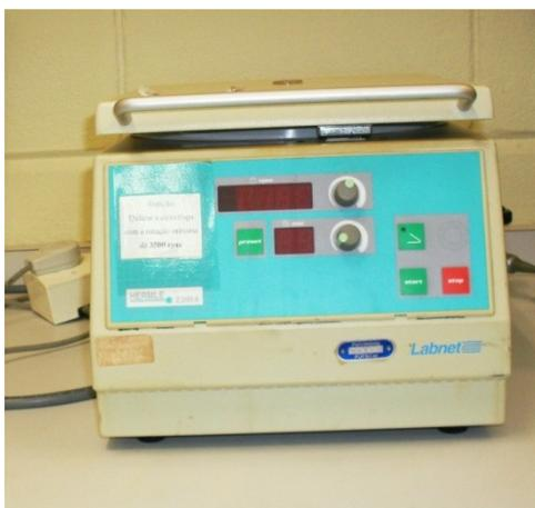
**Figura D.1.** Centrífuga utilizada na digestão das amostras.
