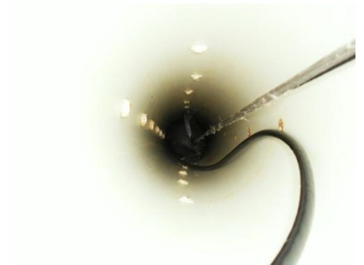
**Imagem 5.28.** Interior do tubo perfurado na altura da trincheira de infiltração, com o material de coleta posicionado no fundo.
