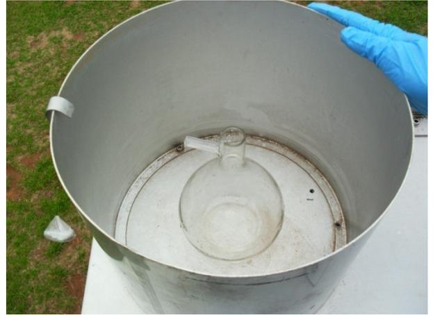
**Figura 5.10.** Posicionamento do frasco coletor no cilindro do *wet only*.
