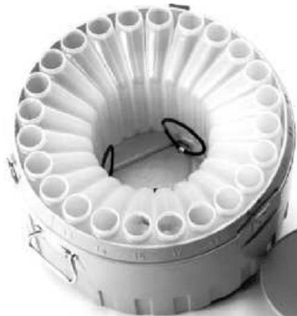
**Figura 5.31.** 24 frascos de polietileno de 500 mL de capacidade volumétrica.
