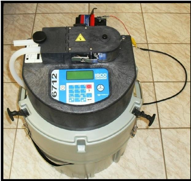
**Figura 5.16.** *Sampler 6712C (ISCO, EUA).*
