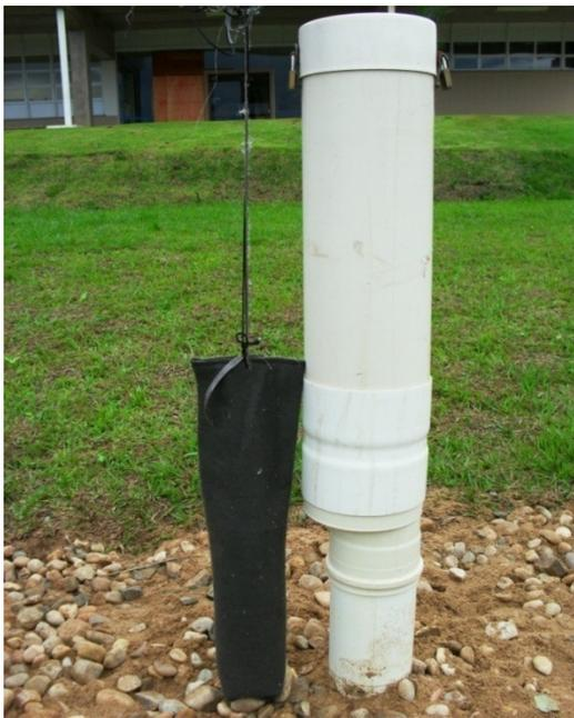
**Imagem 5.25.** Material de coleta ao lado do poço de monitoramento para demonstração de suas dimensões.
