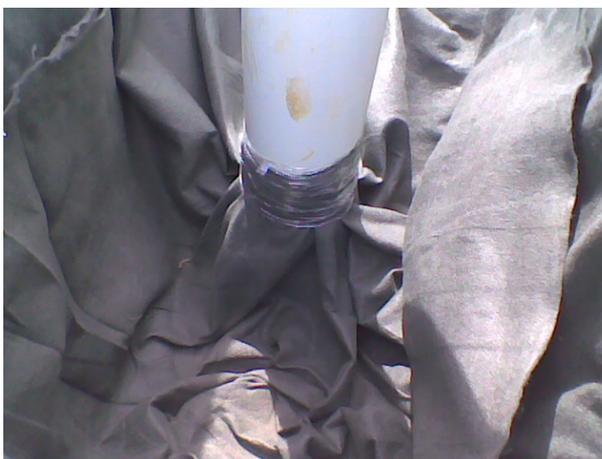
**Figura B.27.** Detalhe da vedação com fita adesiva.
