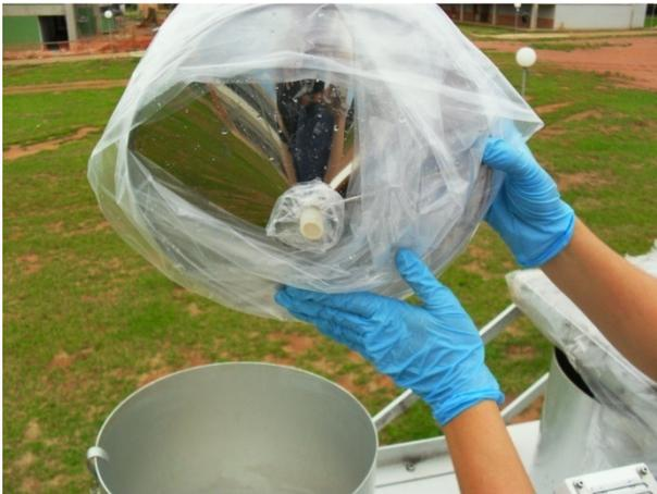
**Figura 5.11.** Mangueira inserida internamente no funil de aço inox, revestido por saco de polietileno.
