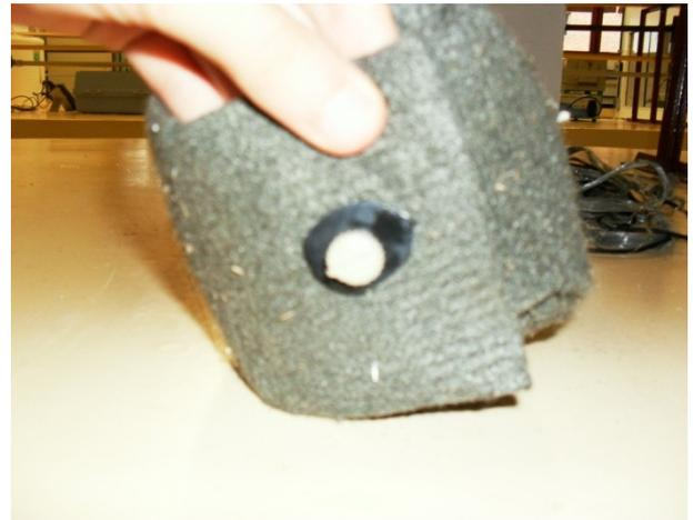
**Imagem 5.22.** Fechamento da bolsa com parafuso plástico e borracha.
