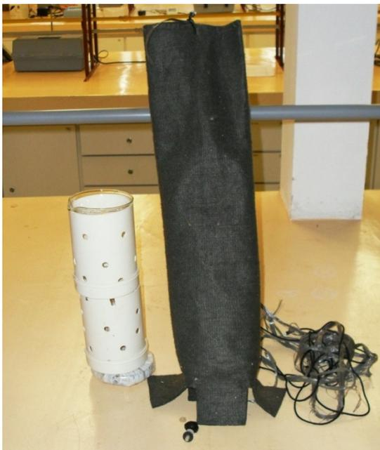
**Imagem 5.23.** Posicionamento dos tubos e béqueres sobre um peso de 1 Kg, dentro da "bolsa de geotêxtil" costurada.
