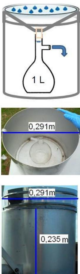
**Figura 5.8.** Esquema proposto para coleta no *wet only*.
