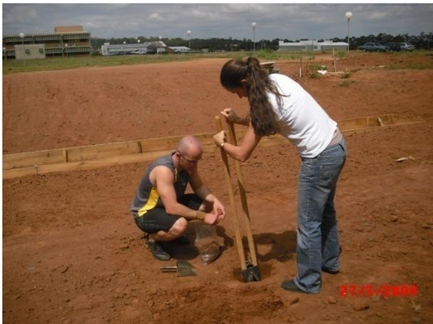
**Figura A.1.** Extração de amostra de solo (área da vala) para análises físicas laboratoriais durante a construção do sistema de infiltração.
