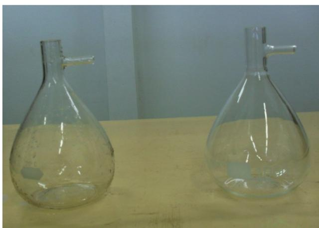
**Figura 5.29.** Balão volumétrico de 1 L adaptado (e réplica) para o encaixe com o funil dentro do cilindro do *wet only*.
