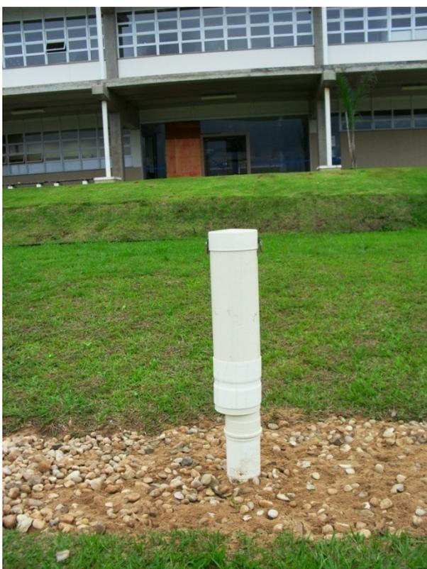
**Figura B.31.** Poço de monitoramento quali-quantitativo após adaptação da altura.
