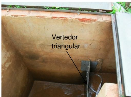
**Figura B.5.** Vertedor triangular reinstalado no canal retangular.
