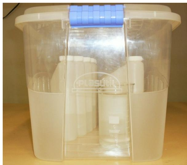
**Figura 5.35.** Armazenamento de frascos do Grupo 2 em estado de descontaminação com solução 5% (v/v) de  $\text{HCl}$ .
