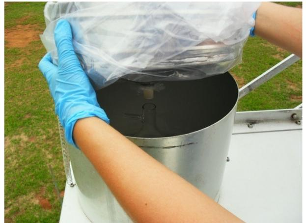
**Figura 5.12.** Posicionamento da mangueira para encaixe na abertura do frasco de coleta.
