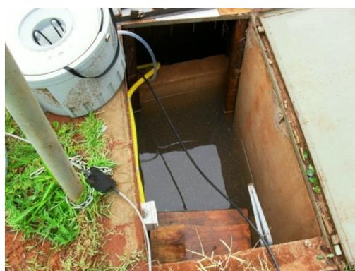
**Figura B.4.** Extravazão do abrigo após evento intenso em 18/01/2011.
