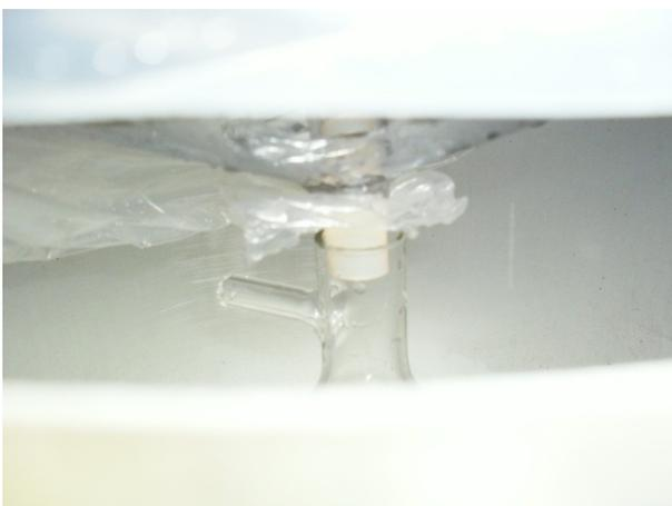
**Figura 5.13.** Encaixe da mangueira do funil no frasco de coleta dentro do cilindro do *wet only*.
