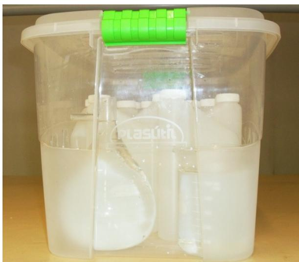
**Figura 5.34.** Armazenamento de frascos do Grupo 1 em estado de descontaminação com solução 10% (v/v) de  $\text{HNO}_3$ .
