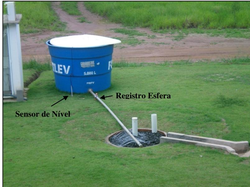
**Figura 35:** Descargas de água com o reservatório para simulação de chuvas
