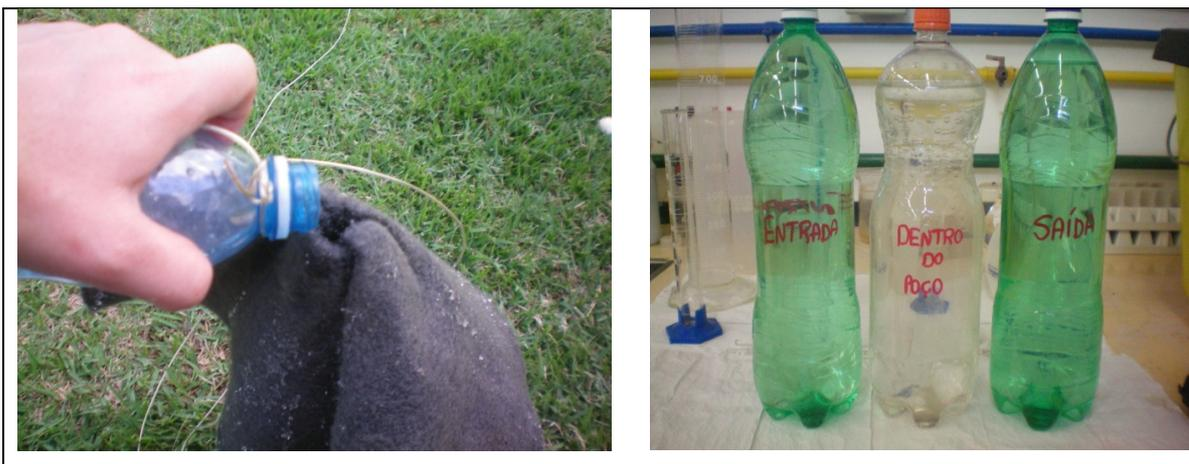
**Figura 43:** Amostras de água coletadas no vertedor (entrada), dentro do poço, e filtragem da água em manta geotêxtil para representar a saída de água do mesmo
