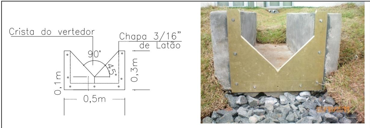
**Figura 25:** Vertedor triangular produzido com chapa de latão de 3/16” e 5 mm de espessura, e ângulo de abertura de 90°
