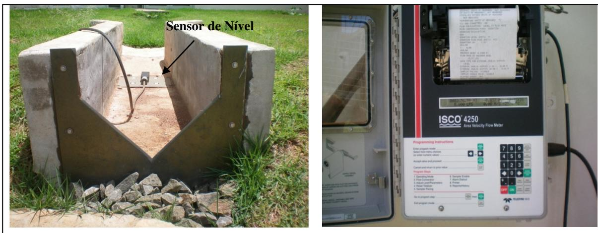
**Figura 33:** Medidor de nível ISCO 4250 instalado na canaleta e utilizado para coleta de dados
