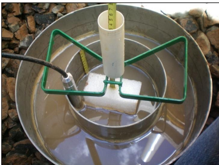
**Figura 38:** Ensaio de determinação da permeabilidade do solo realizada pelo método de Duplo Anel no fundo do poço
