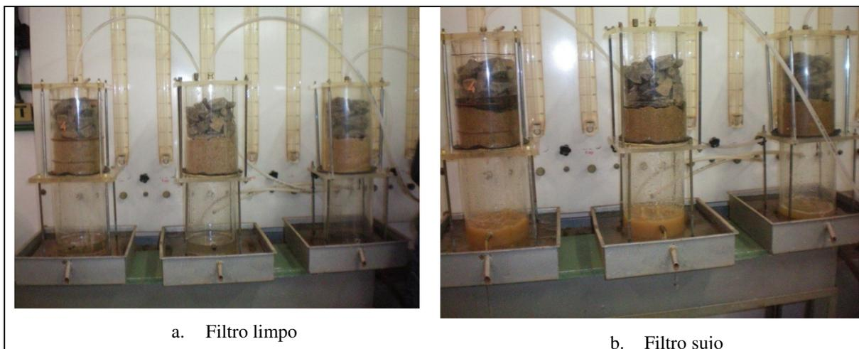
**Figura 37:** Amostras de geotêxtil novo, brita lavada e areia nova sem uso compondo o filtro a (esquerda) e amostras de geotêxtil novo, areia e brita retiradas do filtro da tampa do poço após oito meses de sua construção.
