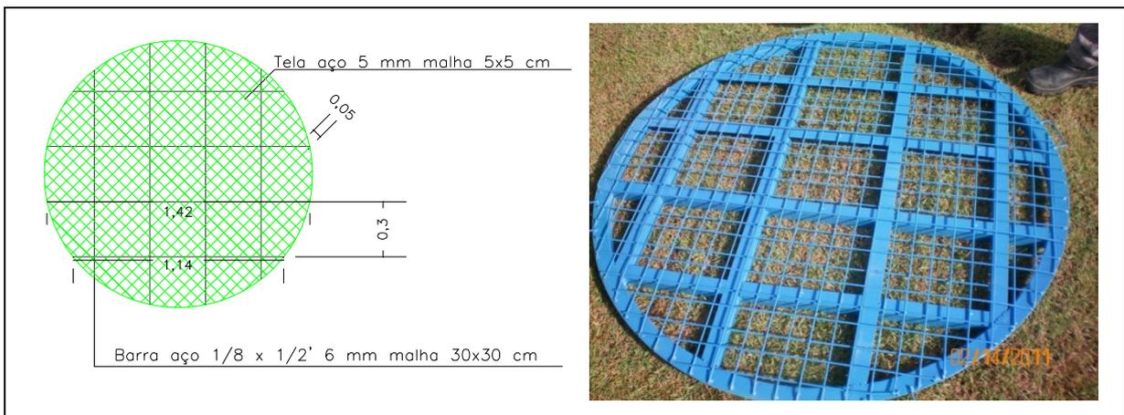
**Figura 19:** Tampa de metal colocada sobre o poço construída com barra cantoneira de aço com dimensões 1/8 x 1/2' e 6 mm de espessura formando uma malha inferior de 30 x 30 cm e malha superior de 5 x 5 cm
