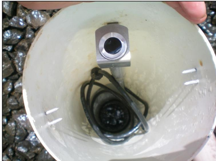
**Figura 34:** Medidor de nível instalado dentro do tubo de PVC utilizado para coleta de dados de nível de água dentro do poço
