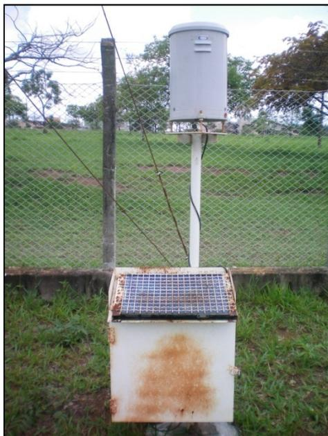
**Figura 32:** Pluviógrafo eletrônico instalado na estação climatológica da UFSCar e utilizado para coletas de dados de precipitação
