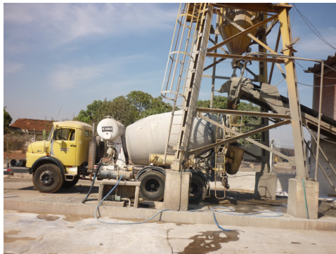
Figura 1 – Caminhão betoneira sendo carregado sob um silo de cimento em uma concreteira
