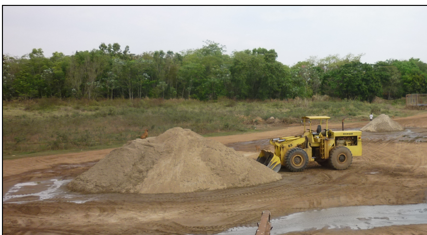
Figura 11 – Empilhamento e revolvimento do material
