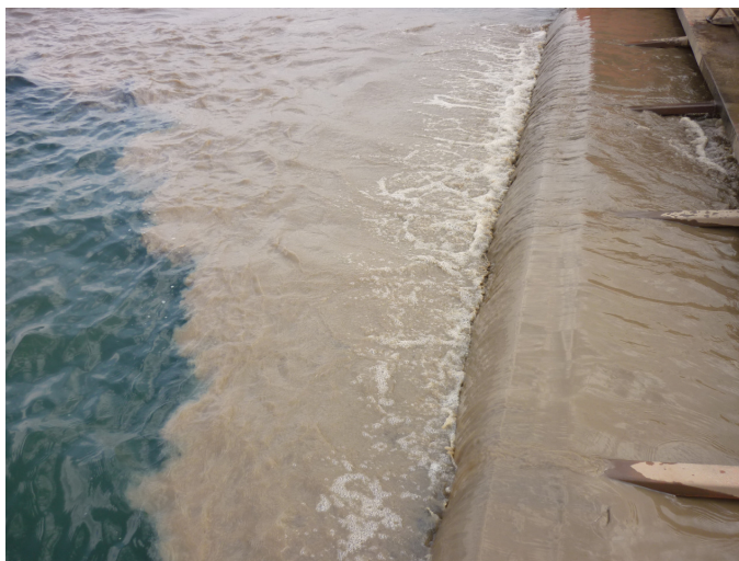
Figura 19– Extravase do material pela lateral do barco durante carregamento
