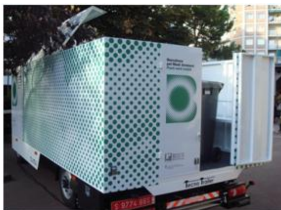
Figura 3 – Caminhão denominado Punto Verde Móvel, destinado a recepção de resíduos em diversos locais.
