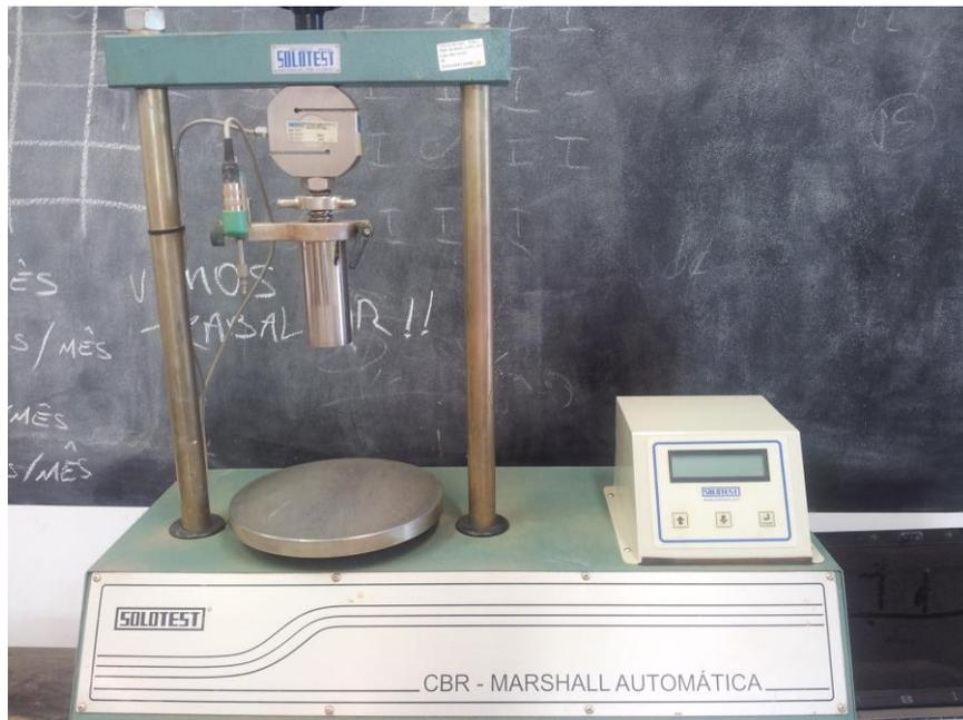
**Figura 24**– Prensa utilizada no ensaio de CBR e de Compressão Simples
