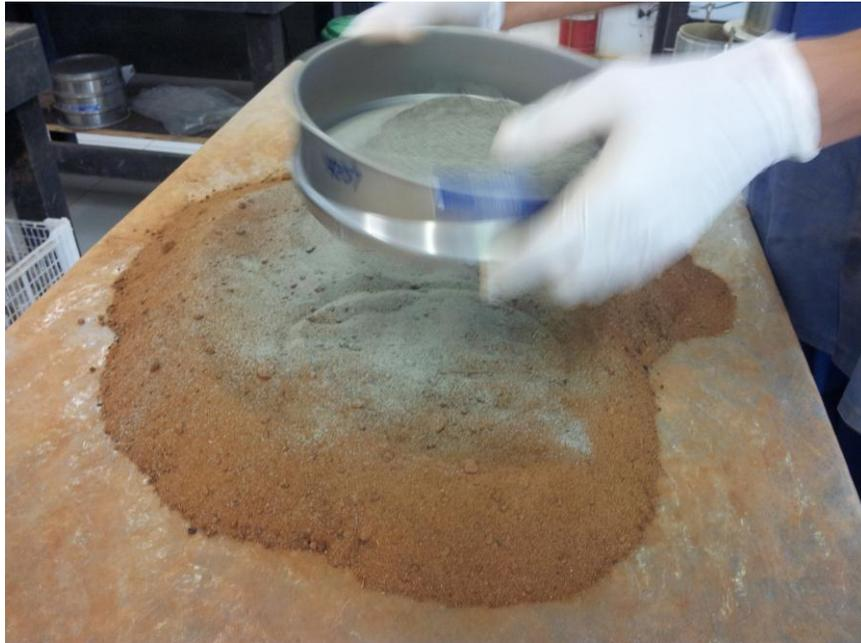
**Figura 22** – Dosagem de Solo- Cimento (5%), 5.000g de solo para 250g de cimento.
