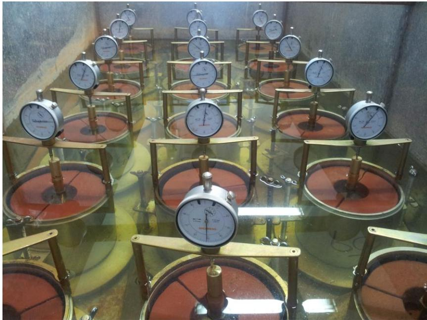
**Figura 23** – Corpos de prova durante o período de imersão (quatro dias).
