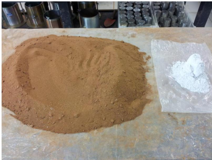
**Figura 21** – Dosagem de Solo- Cal (5%), 5.000g de solo para 250g de cal.
