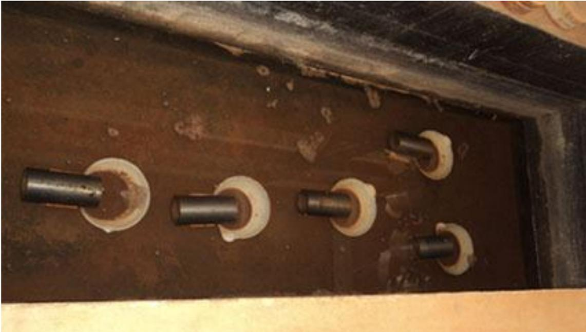
**Figura 27** - Os cinco corpos de prova (ST-04) moldados e imersos durante o ensaio de perda de massa por imersão
