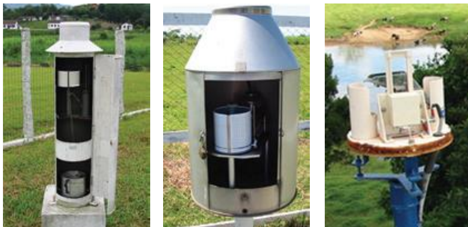
Figura 3.5. Pluviógrafo de boia, balança e cubas basculantes, respectivamente. Fonte: (BRASIL, 2009)
