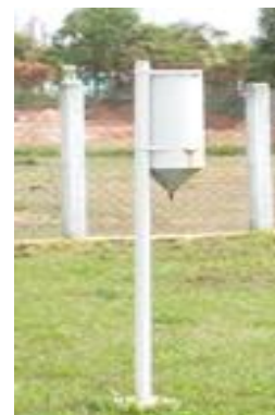
Figura 5.6. Pluviômetro tipo Ville de Paris
