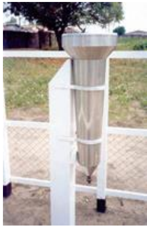
Figura 3.3. Pluviômetro “Ville de Paris” Fonte: (BRASIL, 2009)
