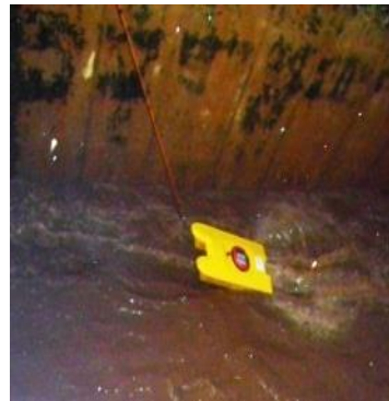
Figura 5.16. Instabilidade do ADCP na água
