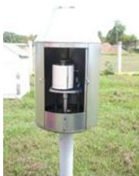
Figura 5.5. Pluviógrafo modelo Balança Sifão
