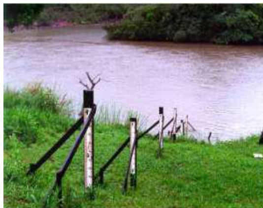
Figura 3.7. Seção de réguas linimétricas Fonte: (SOUZA,2003).
