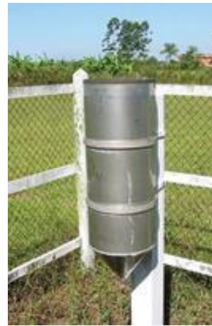
Figura 3.4. Pluviômetro modelo DNAEE Fonte: (BRASIL, 2009)
