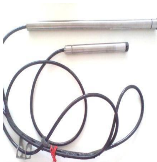
Figura 3.10. Linígrafo de pressão com sensor eletrônico. Fonte: Acervo pessoal.
