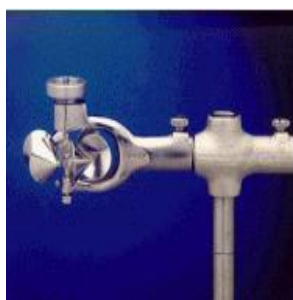
Figura 3.12. Molinete do tipo Price. Fonte: (SOUZA, 2003)
