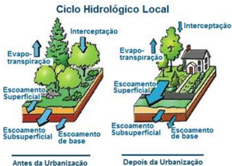
Figura 3.2. Balanço hídrico antes e depois da urbanização Fonte: Adaptado de Schueler (1987) e National Research Council (2008)
