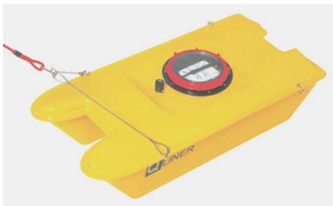
Figura 3.17. Medidor ultrassônico baseado no efeito Doppler do tipo ADCP Fonte: Acervo pessoal
