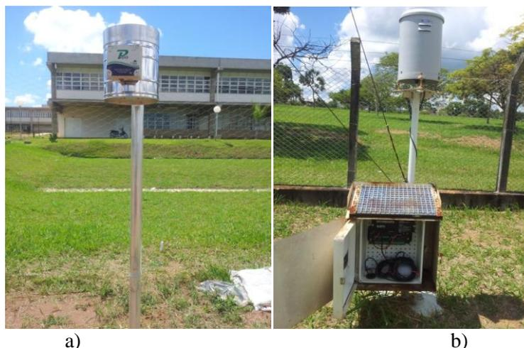
Figura 2. 18 – Pluviógrafos instalados no campus da UFSCar
