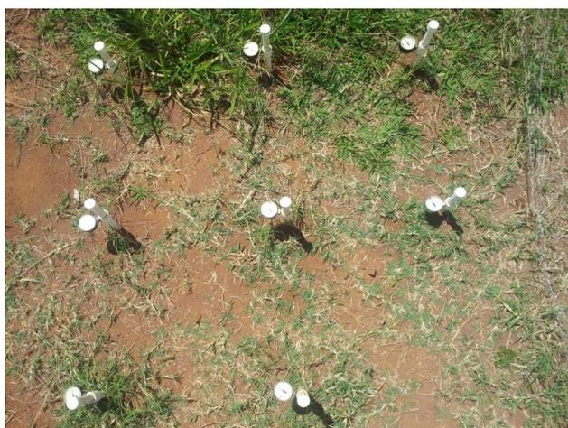
Figura 2. 17 - Tensiômetros instalados na área a profundidades 0,10m; 0,25m; 0,50m; 0,80m; 1,00m; 1,50m; 2,00m e 2,50m.
