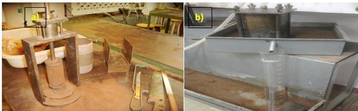
Figura 2. 11 – Ensaio de permeabilidade em laboratório
