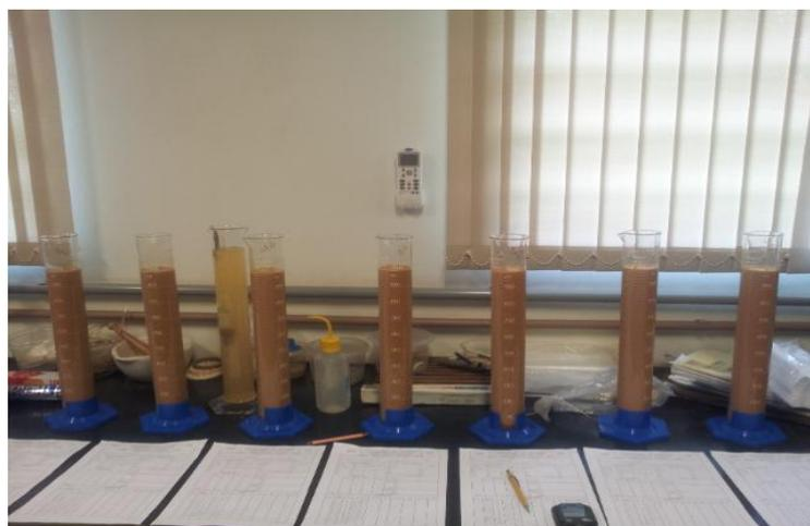
Figura 2. 10 - Ensaio de granulometria conjunta das diferentes profundidades.
