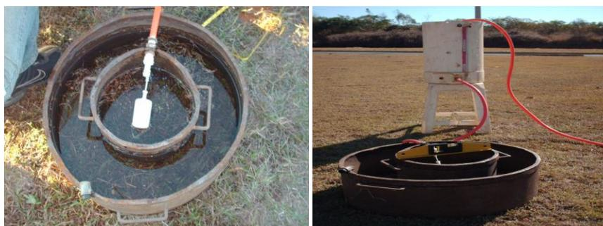
Figura 2. 14 - Ensaio de duplo anel de carga constante instalados em campo.
