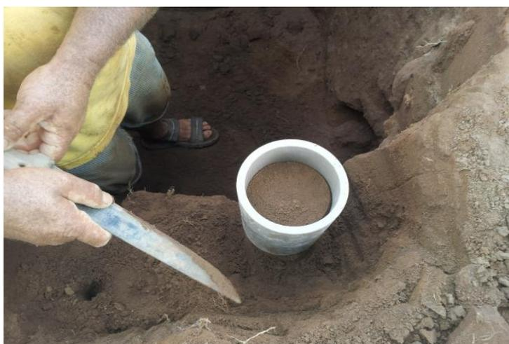
Figura 2. 9 - Coleta de amostras indeformadas em pivô na profundidade de 20cm.
