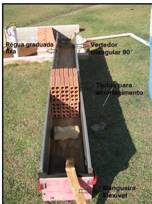
Figura 18 - Canaleta receptora de água do caminhão pipa
