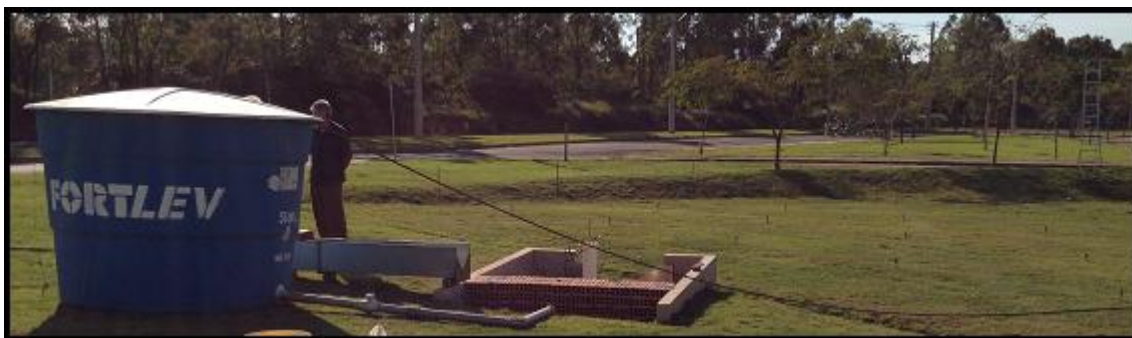
Figura 17 - Caixa de água de 5000L usada no ensaio de campo
