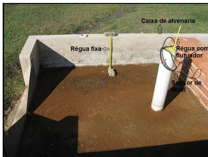
Figura 21– Sensor de nível e réguas para leitura do nível de água
