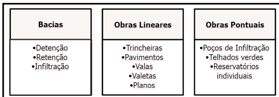
Figura 2 - Tipo de Técnicas Compensatórias e estruturas pertencentes a cada grupo. Fonte: Angelini Sobrinha (2012).
