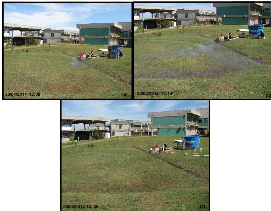
Figura 39 - Ensaio de campo 3 com caixa de água e caminhão pipa: (a) início do ESD no plano (12:08), (b) momento com máxima área molhada (12:14), (c) final da infiltração no plano (12:36)
