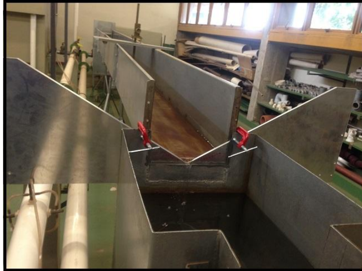
Figura 14 – Instalação de vertedor 120° em laboratório
