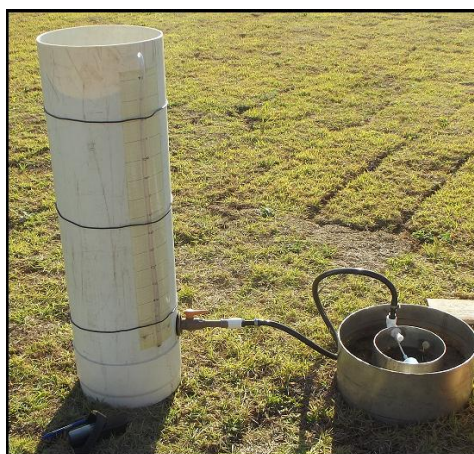
Figura 10 – Equipamentos usados no ensaio de Duplo Anel
