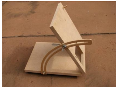
Figura 60: Anteparo de madeira para medir a insolação solar
