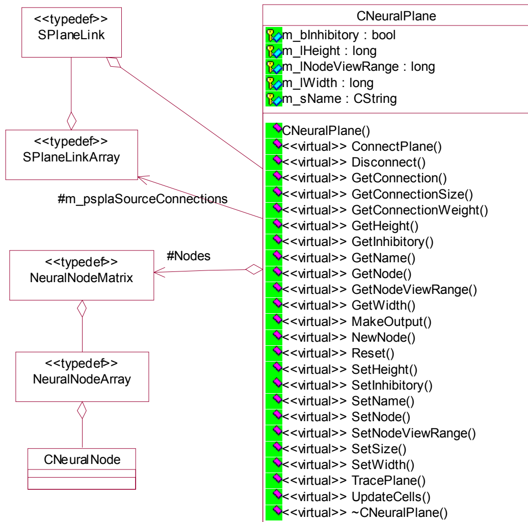
Figura 19 - Diagrama de classe da Classe CNeuralPlane, estruturas auxiliares e relacionamento com a classe CNeuralNode
