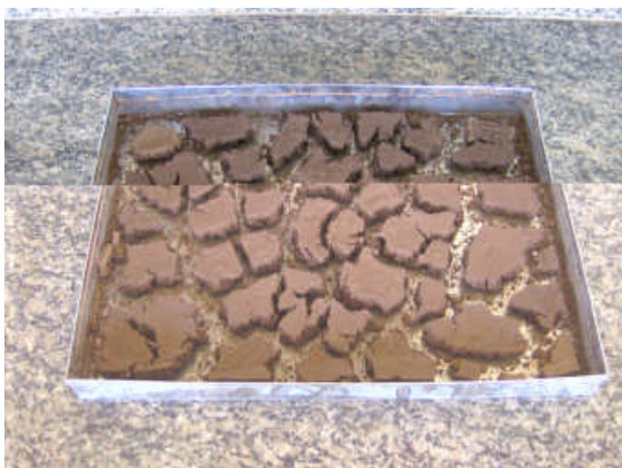
**FIGURA 4.11** – Fase sólida do lodo após secagem em estufa por 24 h à temperatura de 110 °C.
