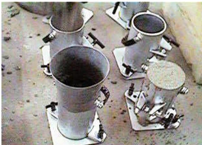
**FIGURA 4.19** – Moldes de aço cilíndricos de (10 x 20) cm.
