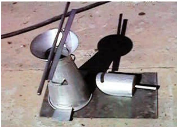
**FIGURA 4.18** – Equipamentos utilizados no ensaio de determinação da consistência do concreto.
