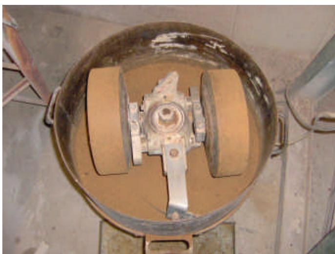
**FIGURA 4.12** – Triturador de agregados miúdos usado para moer o lodo seco.
