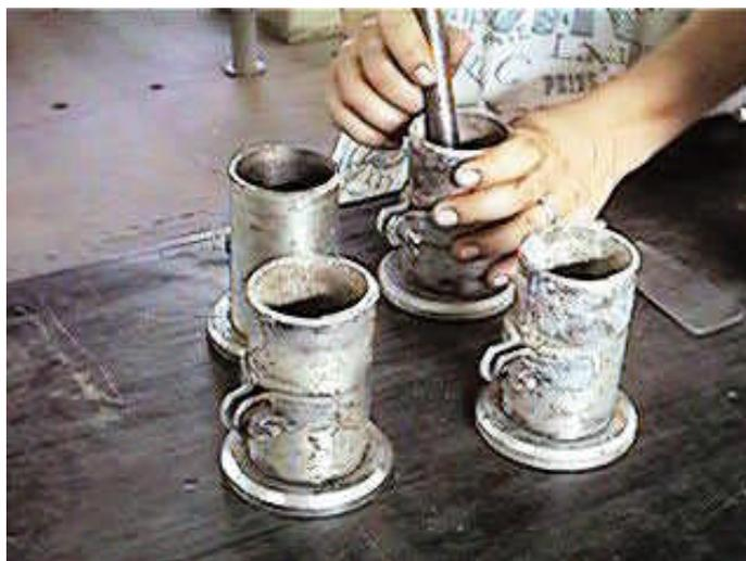
**FIGURA 4.24** – Moldes cilíndricos de (50 x 100) mm dos corpos-de-prova das argamassas.
