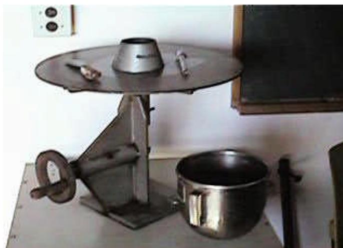
**FIGURA 4.22** – Aparelho para a determinação do índice de consistência das argamassas.
