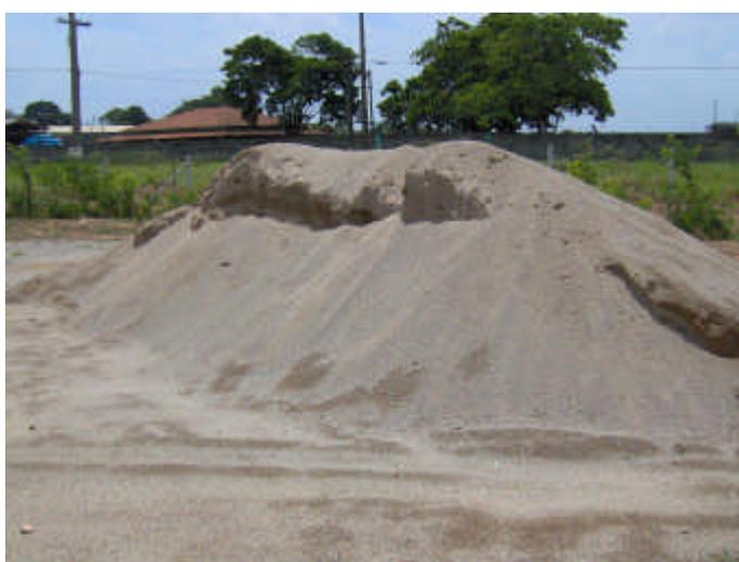
**FIGURA 4.14** – Agregado miúdo reciclado produzido na Usina de Reciclagem de São Carlos.
