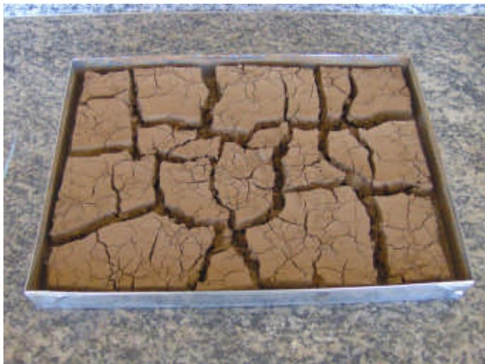
**FIGURA 4.10** – Lodo após pré-secagem por 48 horas ao ar livre à temperatura ambiente.
