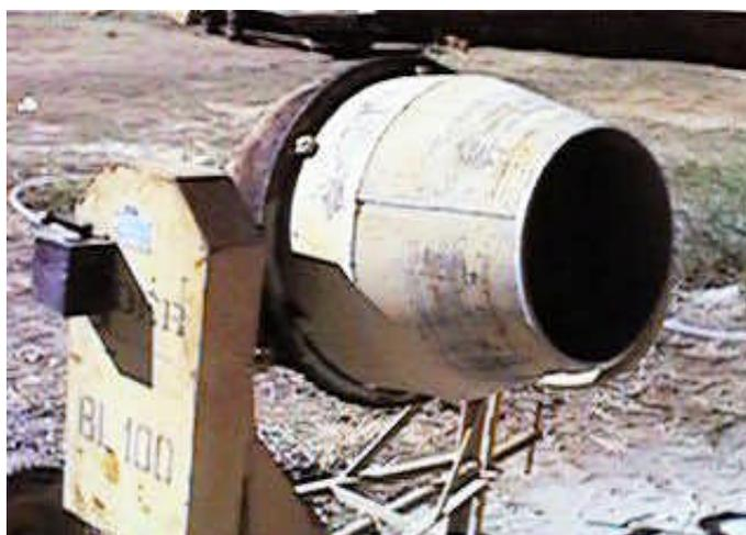
**FIGURA 4.17** – Betoneira utilizada para a mistura dos componentes do concreto.
