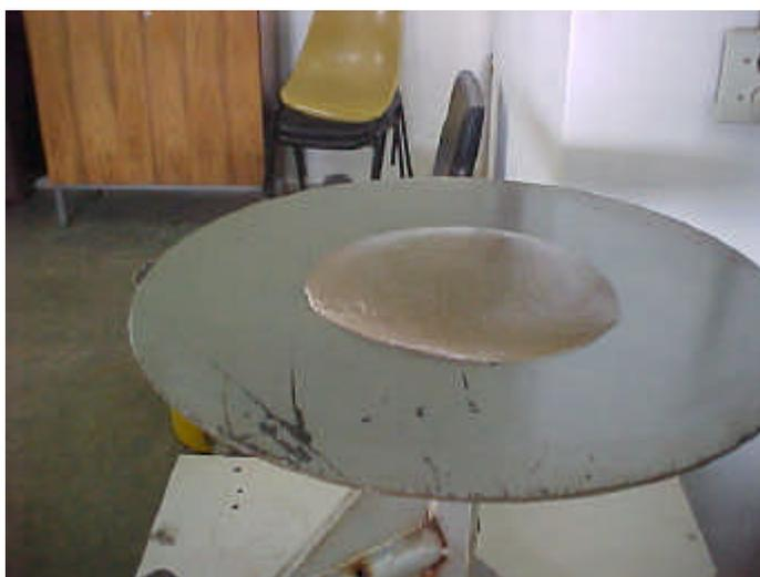
**FIGURA 4.23** – Argamassa sobre a mesa do aparelho de determinação do índice de consistência normal.
