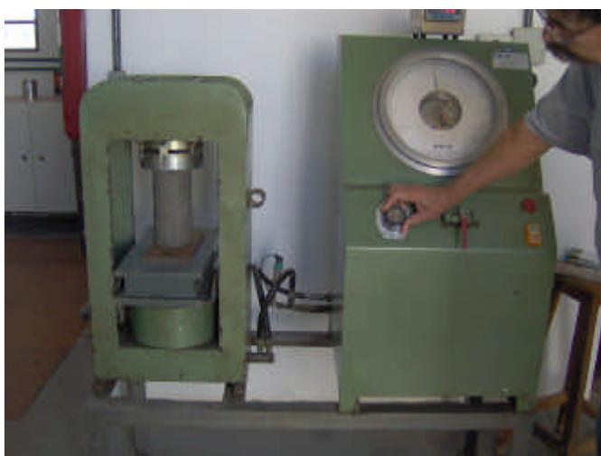
**FIGURA 4.20** – Prensa utilizada no ensaio de compressão axial de corpos-de-prova cilíndricos.
