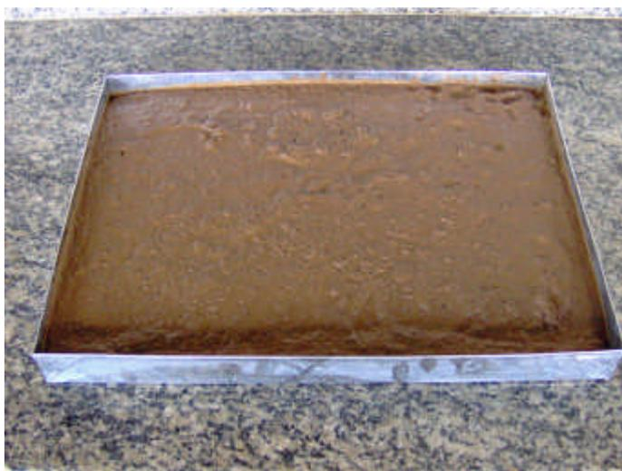
**FIGURA 4.9** – Lodo em repouso em bandeja metálica logo após ter sido coletado na Estação de Tratamento de Água de São Carlos.
