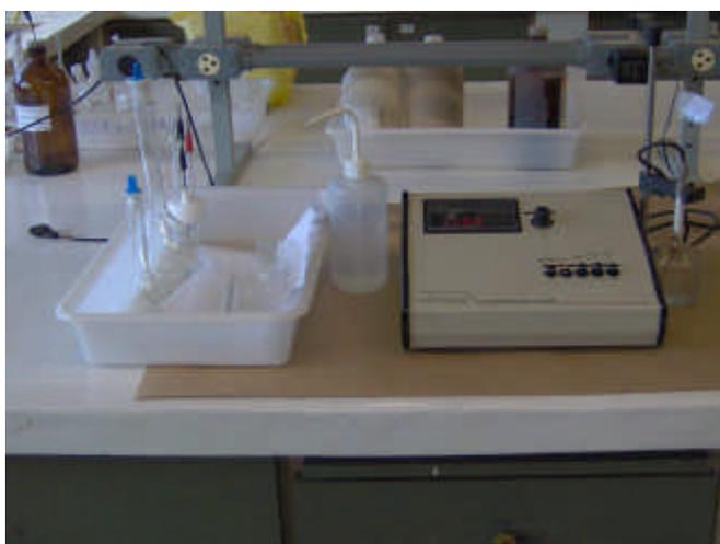
**FIGURA 4.27** – Condutímetro utilizado na determinação da condutividade do extrato lixiviado do processo de solubilização do CRE3L.
