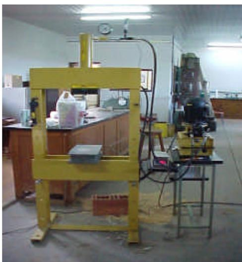
**FIGURA 4.25** – Prensa digital utilizada para a realização dos ensaios de compressão axial das argamassas de assentamento.
