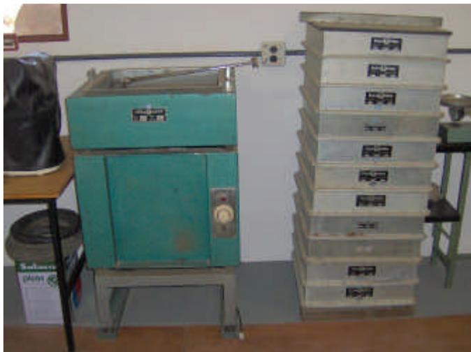
**FIGURA 4.2** – Peneirador automático de agregados graúdos.
