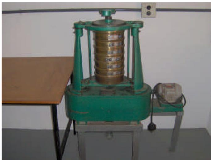
**FIGURA 4.1** – Peneirador automático de agregados miúdos.
