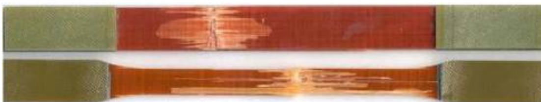
Figura 27 - Corpos de prova elaborados segundo as normas ISO 527-4 e ISO 527-5 Fonte: Broughton & Lodeiro (2000)
