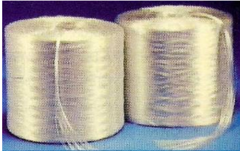
Figura 4 - Bobinas de roving Fonte: Saint-Gobain – VETROTEX – 2006
