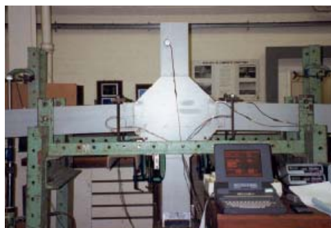
a – Ensaio de ligação de 4 vigas
