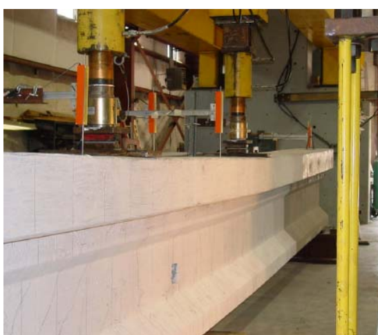
Figura 91 - Viga não danificada, de controle, sendo ensaiada Fonte: Rehm (2005)
