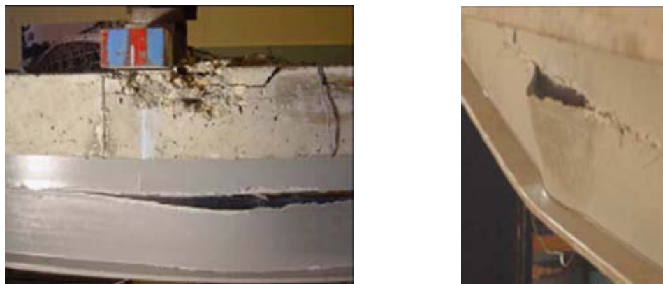
Figura 87 “a” e “b” – Detalhes da ruptura da viga.
