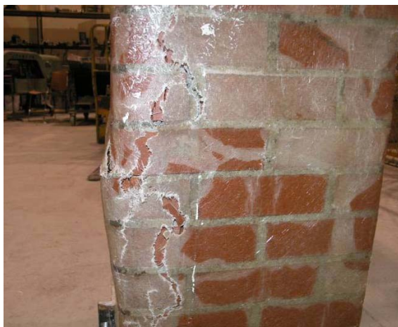
Figura 111 – Pilar reforçado com GFRP – Modo de ruptura I e II Fonte: SHAHEEN & SHRIVE, (2005).
