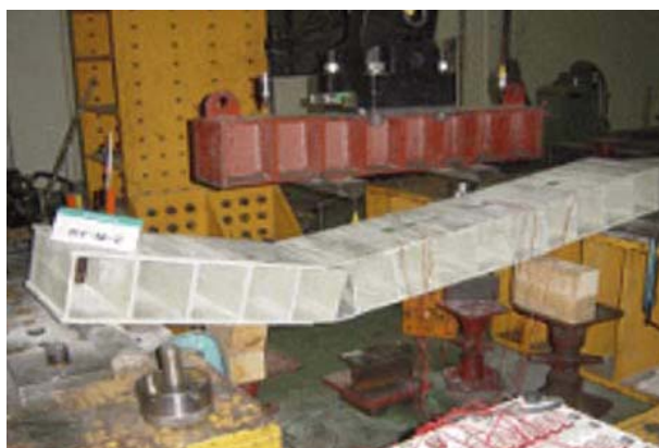
Figura 109 – Elemento após a ruína total, na flexão transversal pura
