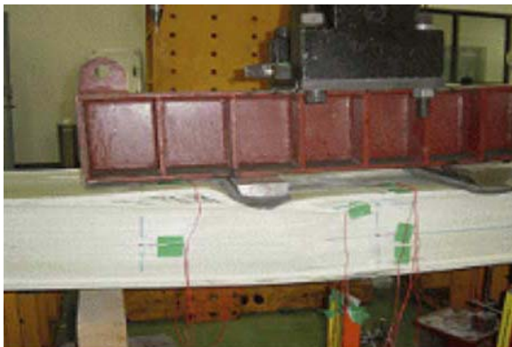
Figura 108 – Elemento após a ruína da mesa da laje no ensaio de flexão pura. Fonte: Park et al. (2004)
