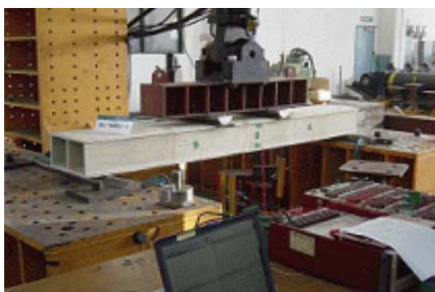
Figura 107 – Elemento de laje colméia para ensaios de flexão pura Fonte: Park et al. (2004).
