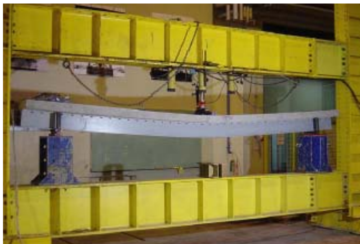
Figura 86 – Viga mista, GFRP – concreto sendo ensaiada Fonte – Correia et al. (2005)
