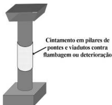
Figura 47 - Reforços em pilares, vigas e tabuleiros de pontes e viadutos.
