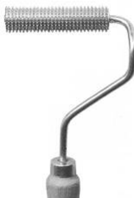
Figura 49– Roletes utilizados para extração de bolhas dos laminados
