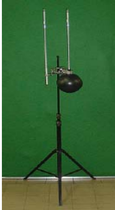
Figura 2.6: Termômetro de globo. Fonte: GOUVÊA, 2004.
