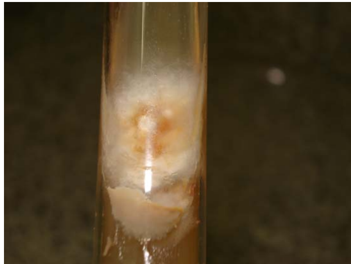
Figura 4.3– Presença de fungos no revestimento de argamassa das habitações estudadas em tubo de ensaio após semeadura realizada na análise microbiológica
