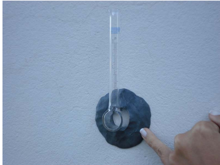
Figura 3.12– Fixação do cachimbo de vidro sobre o revestimento de argamassa
