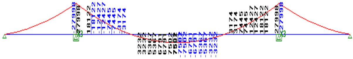
Figura 9.14. Diagrama de momento fletor em kN.m para carga permanente g_2
