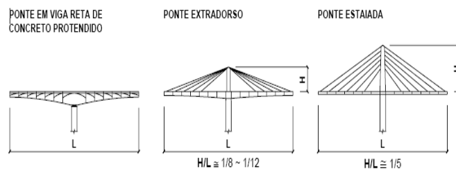
Figura 2.8. Sistemas Estruturais (Fonte: ISHII - 2006)
