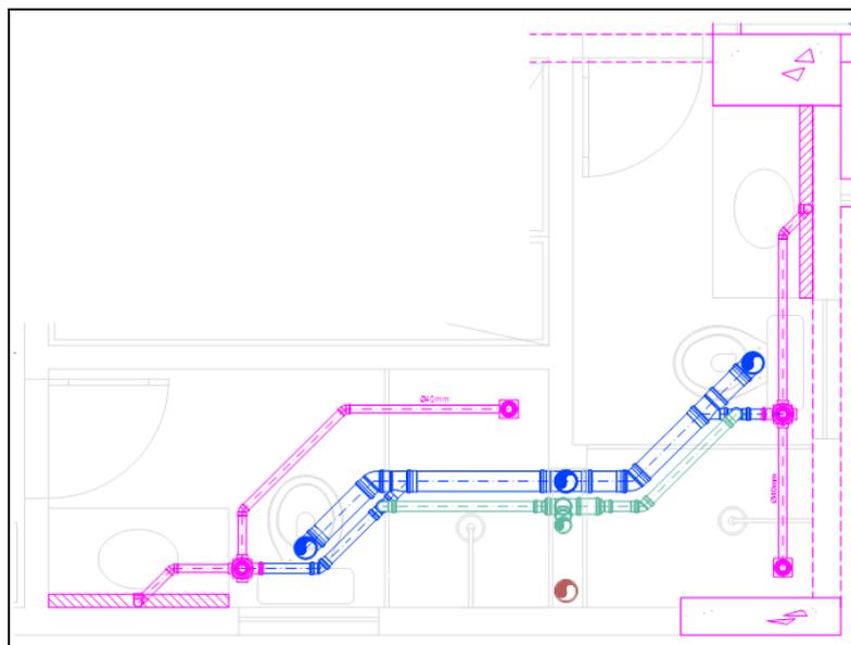
**Figura 53 -Representação dos ramais dos banheiros suíte e social das colunas 1 e 4 do pavimento tipo da obra**
