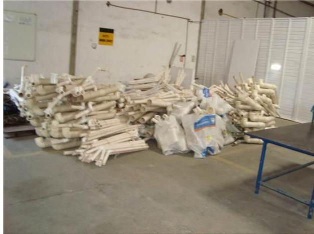
**Figura 30 – Exemplo de *kits* sanitários fabricados em uma central**
