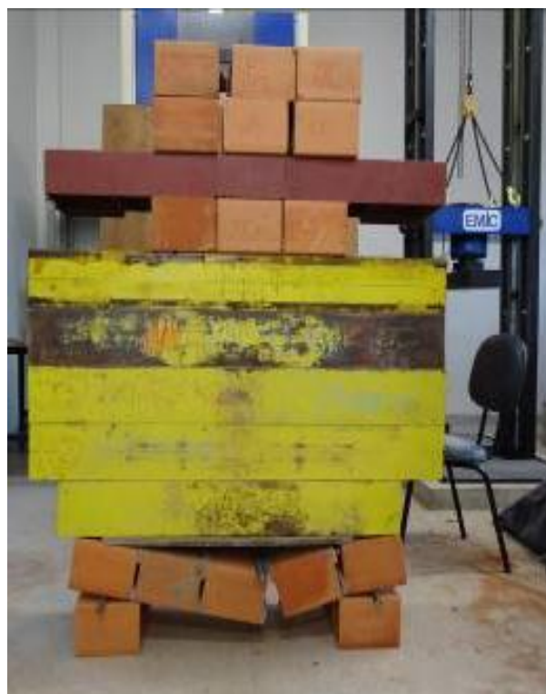
Figura 66 – Exemplo de prisma de aderência rompido
