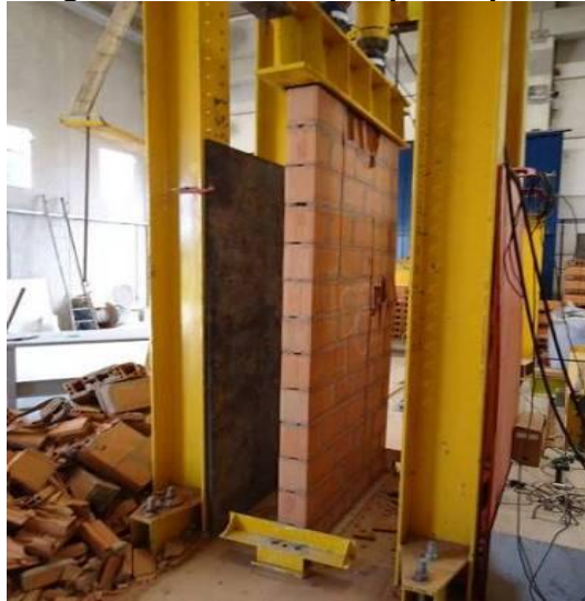
Figura 43– Parede P8 após ruptura
