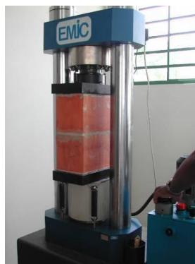
Figura 20 - Ensaio de resistência à compressão de prismas
