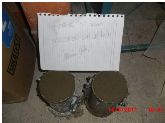
Figura 18 - Exemplo de corpo-de-prova de graute (10x20cm)
