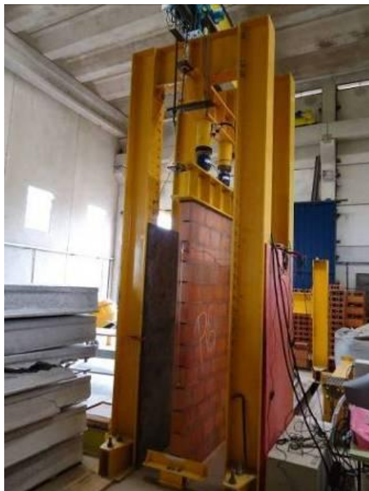
Figura 53 – Parede P6 instrumentada
