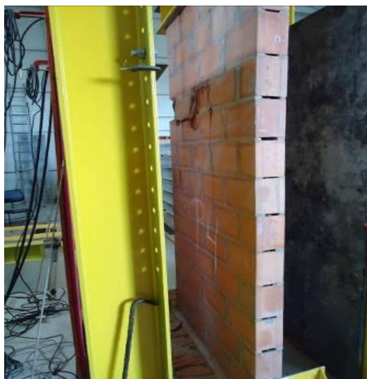
Figura 49 – Parede P4 após ruptura
