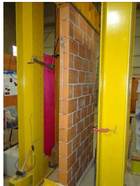
Figura 35 – Parede P3 com instrumentação
