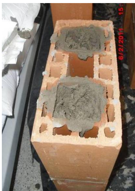
Figura 68 – Corpo-de-prova após 15 minutos do grautamento
