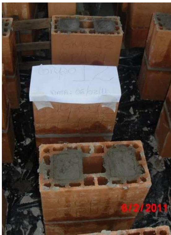
Figura 69 – Prismas do grupo 12, mostrando a retração na ligação bloco/graute
