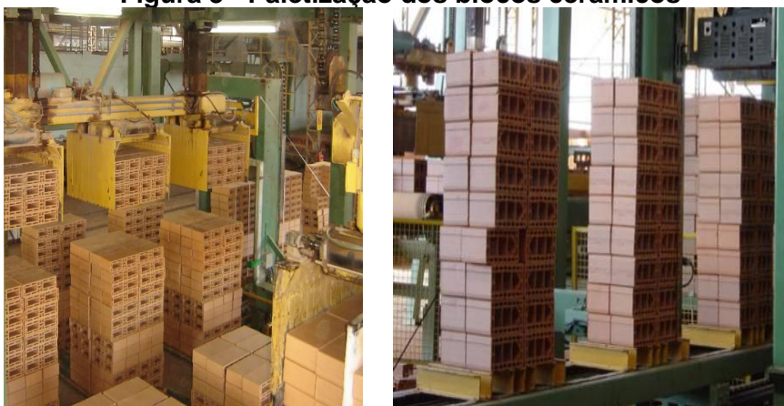
Figura 3 - Paletização dos blocos cerâmicos
