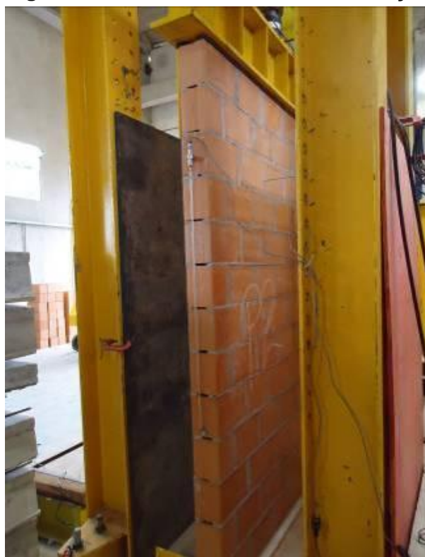
Figura 32 – Parede P2 com instrumentação
