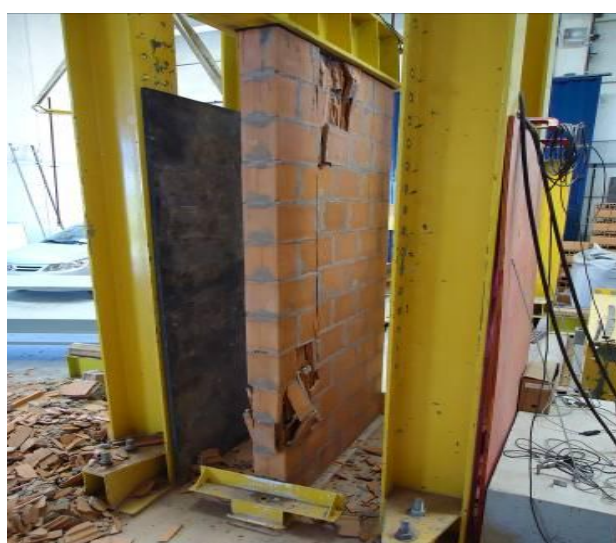
Figura 63 – Parede P12 após ruptura
