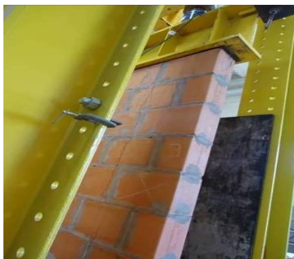
Figura 62 – Forma de ruptura da parede P12 (trinca vertical)
