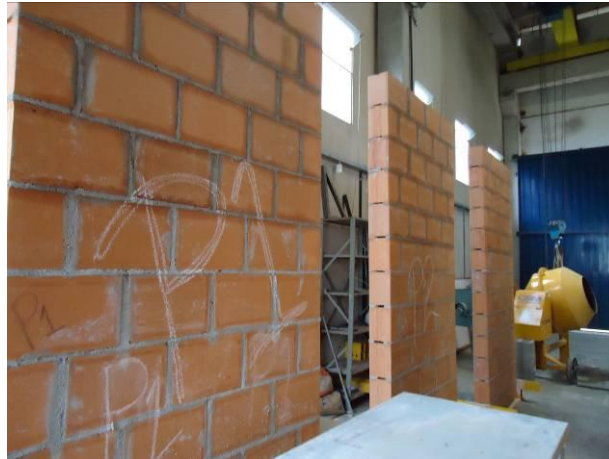
Figura 25 - Paredes do grupo 1 (paredes 1, 2 e 3)
