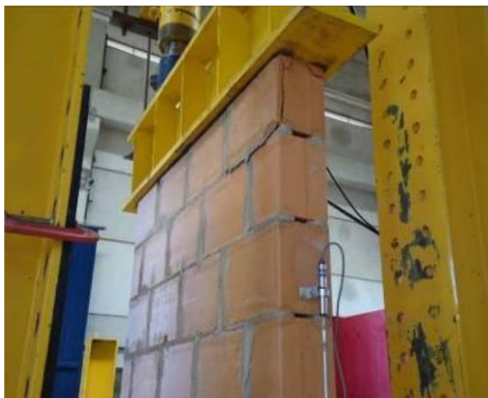
Figura 46 – Parede P9 após ruptura
