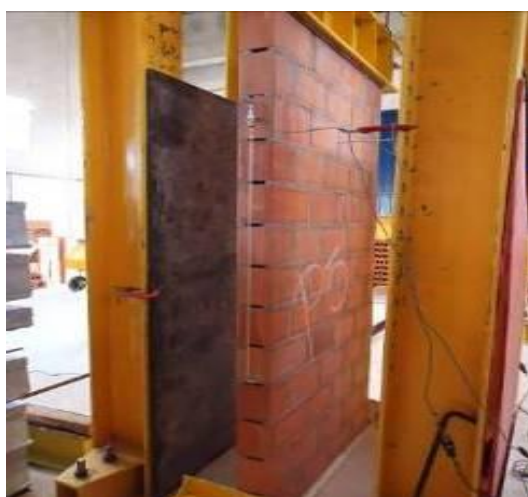
Figura 50 – Parede P5 instrumentada
