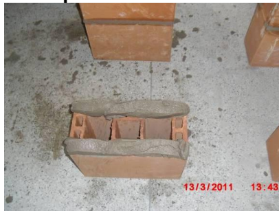
Figura 28 – Forma de colocação da argamassa nos prismas de aderência
