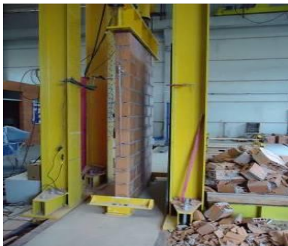
Figura 59 – Parede P11 instrumentada
