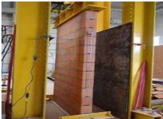
Figura 44 – Parede P9 instrumentada
