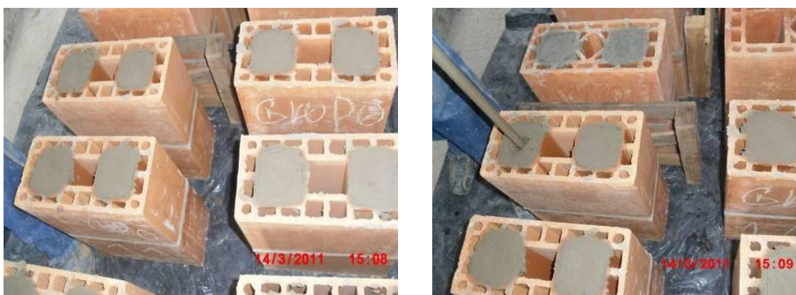
Figura 70 – Prismas do grupo 11 sendo re-adensados
