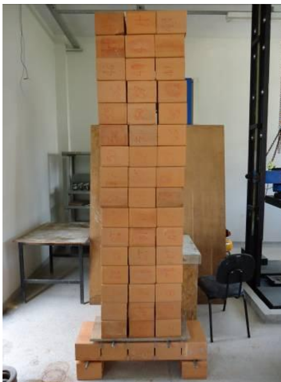
Figura 65 – Exemplo de prisma de aderência carregado
