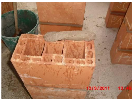
Figura 67 - Exemplo corpos de prova tipo PA3 - molhando os blocos com brocha
