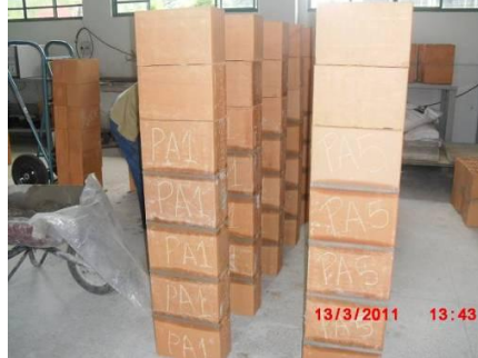
Figura 27 - Prismas de 5 blocos
