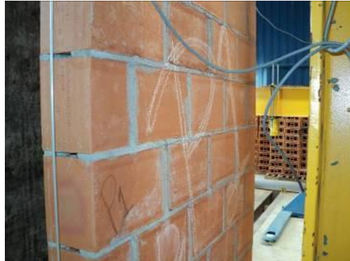
Figura 29 – Parede P1 com instrumentação
