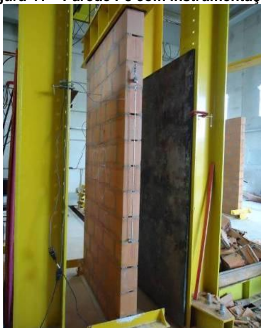
Figura 41 – Parede P8 com instrumentação
