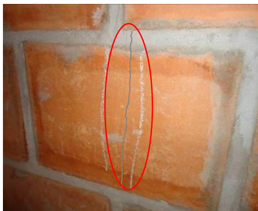
Figura 49 – Parede P4 após ruptura
