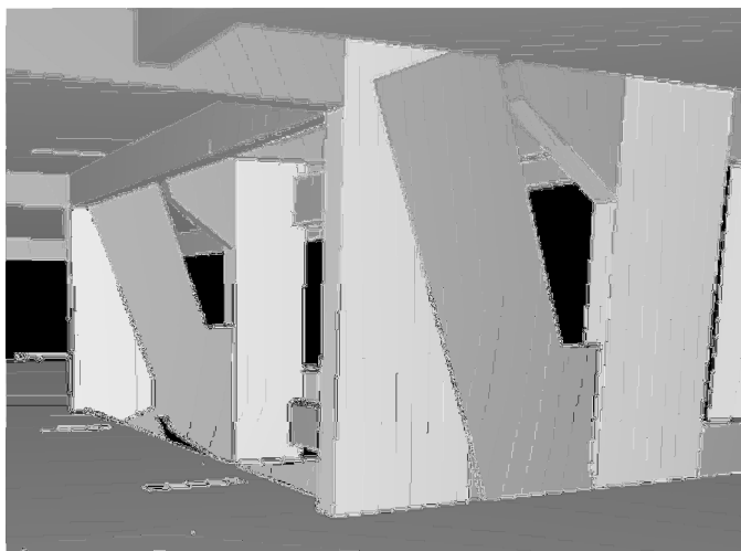
Figura 65: Inserção das barras diagonais no edifício Helena com pilares reduzidos
