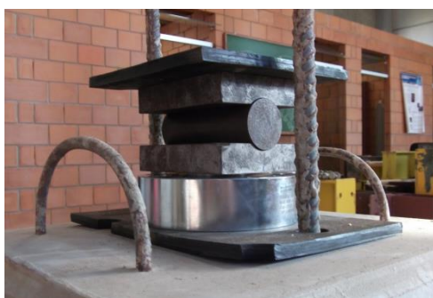
c) Aparato de medição da reação de apoio
