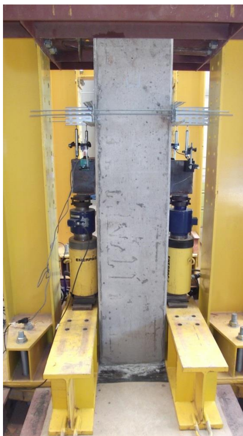
c) Esquema do ensaio PI montado
