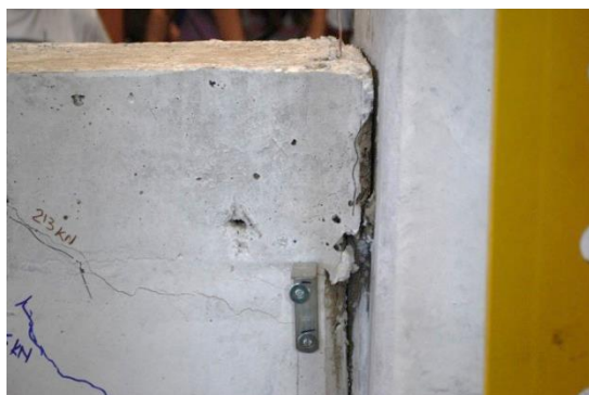
c) Destacamento entre o pilar e a capa de concreto
