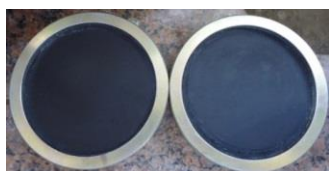
c) Confinamento do corpo-de-prova por neoprene
