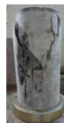
d) Aspecto típico do rompimento
