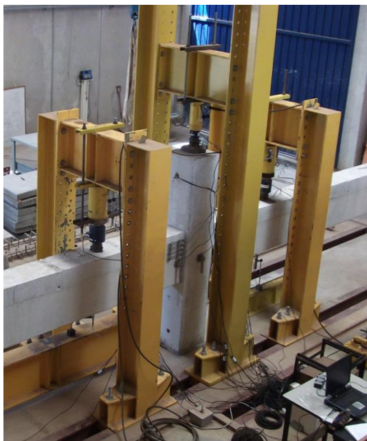
Figura 4.14: Atuadores e células de carga - LI.
