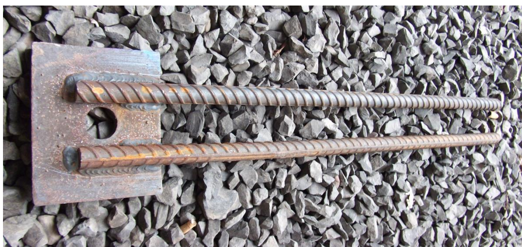
c) Tirantes soldados na chapa de apoio da viga
