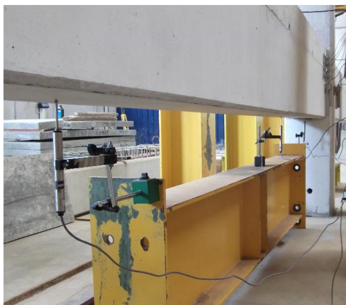
c) No meio do vão da viga e abaixo do perfil metálico
