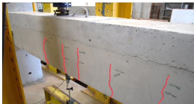
b) Fissuração ao longo do comprimento da viga
