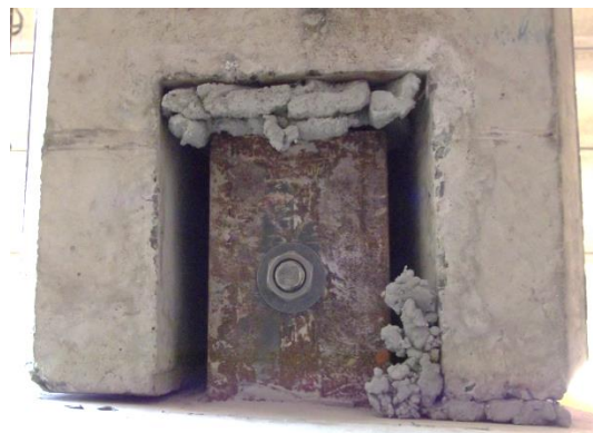
Figura 4.41: Nicho da viga – grauteamento parcial.
