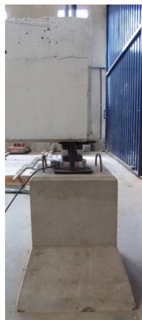
a) Célula de carga entre a viga e o elemento de apoio
