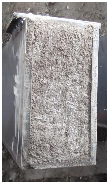
b) Perfil preenchido com concreto
