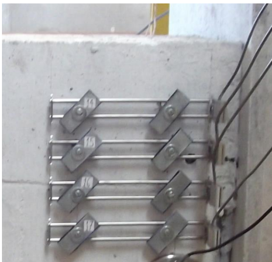
Figura 4.18: Extensômetros de base removível.
