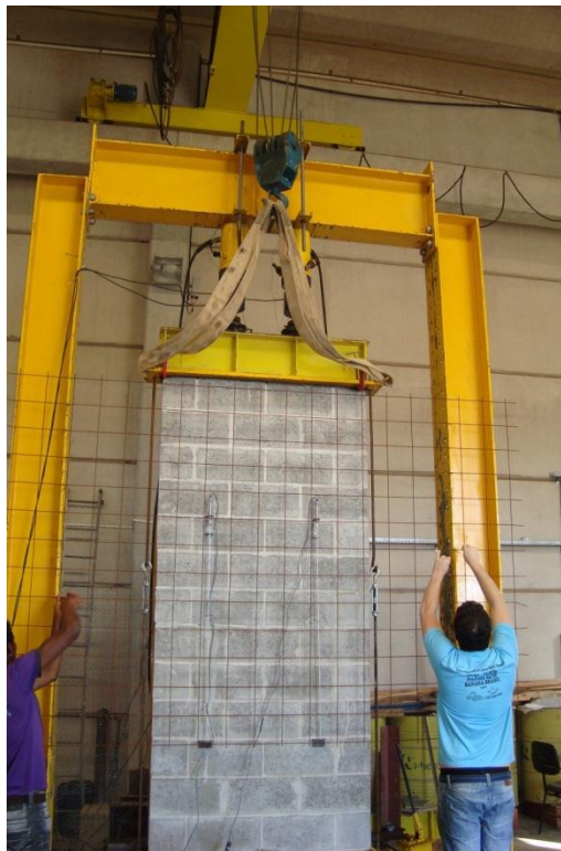
Figura 3-81: Fixação das telas.
