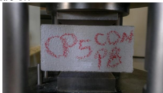
Figura 3-17: Ensaio a compressão de argamassa.
