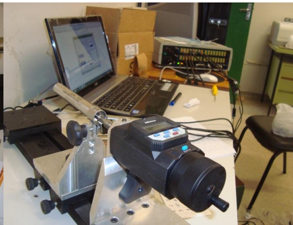
Figura 3-86: Calibração de transdutor I. Figura 3-87: Calibração de transdutor II
