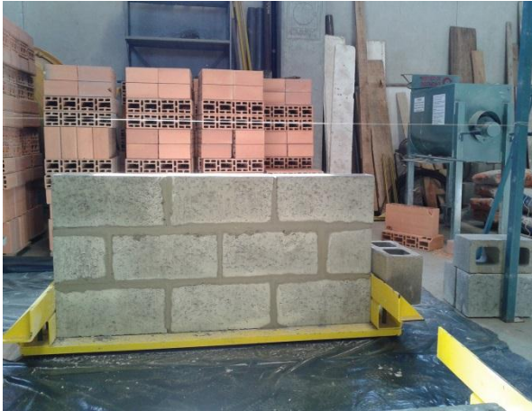
Figura 3-56: Parede até terceira fiada.
