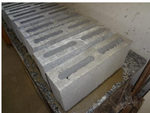
Figura 3-24: Capeamento blocos de concreto.
