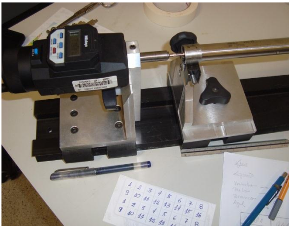
Figura 3-86: Calibração de transdutor I. Figura 3-87: Calibração de transdutor II
