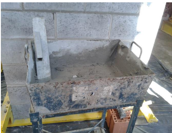
Figura 3-52: Caixa de argamassa.
