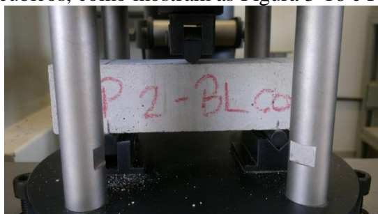
Figura 3-16: Ensaio a flexão de argamassa.
