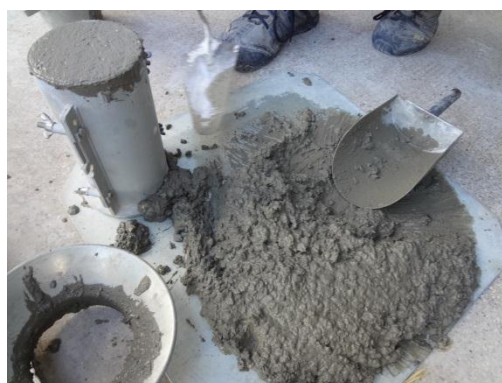
Figura 3-21: Corpo de prova cilíndrico de graute.
