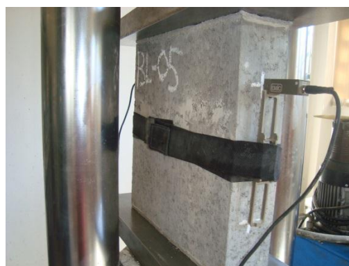
Figura 3-37: Ensaio de módulo de prismas de concreto.
