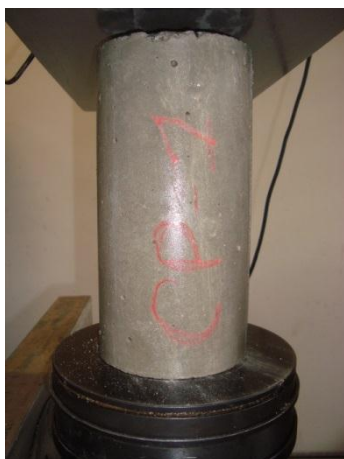
Figura 3-22: Corpo de prova de graute. Figura 3-23: Compressão de graute.
