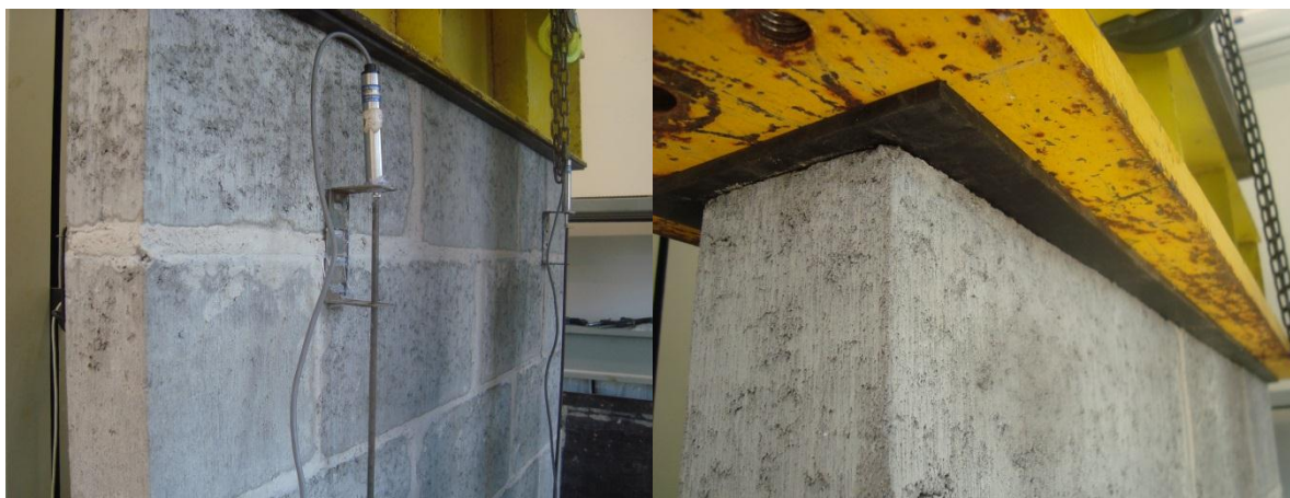
Figura 3-46: Transdutores verticais. Figura 3-47: Capeamento com neoprene.
