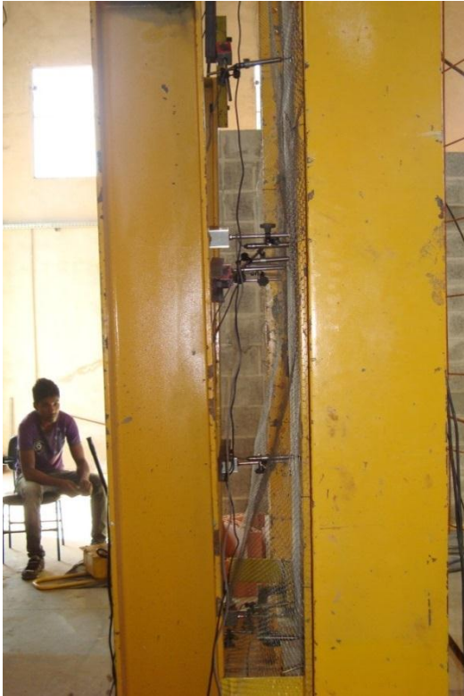
Figura 3-82: Posicionamento dos transdutores horizontais.
