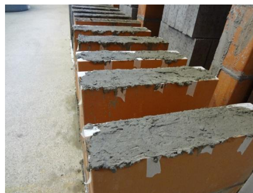
Figura 3-35: Grauteamento de prismas cerâmicos.
