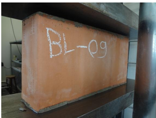
Figura 3-30: Ensaio a compressão de bloco cerâmico.
