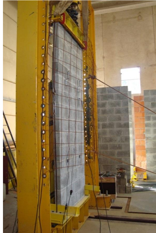
Figura 3-83: Transdutores verticais e extensômetros.
