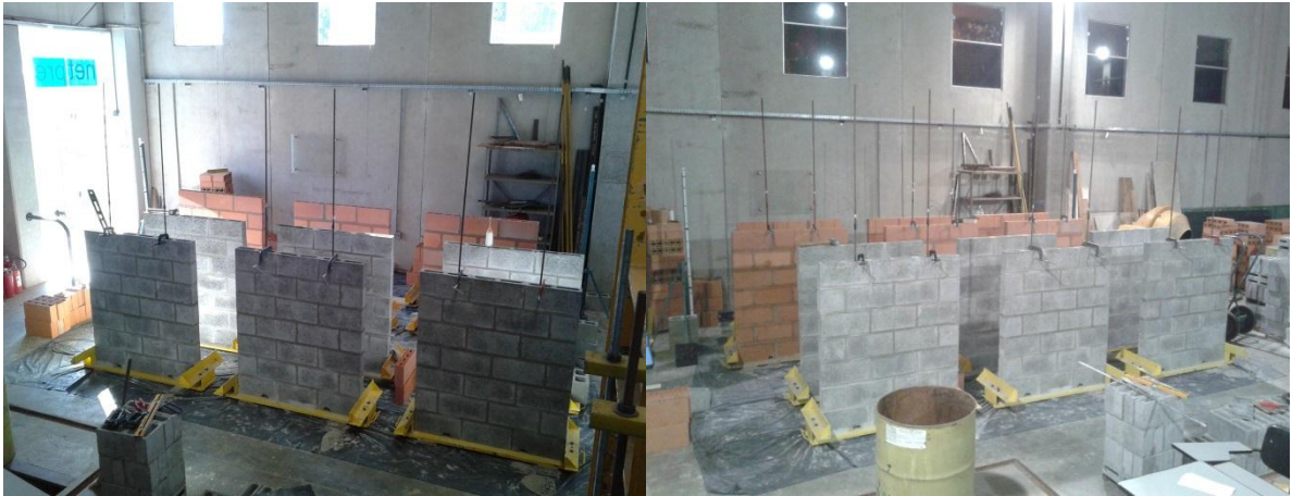
Figura 3-62: Paredes de blocos de concreto, até fiada 7, com barras de aço posicionadas.
