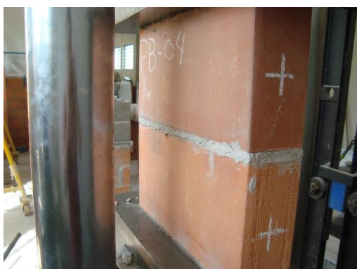
Figura 3-38: Ensaio a compressão de prismas cerâmicos.
