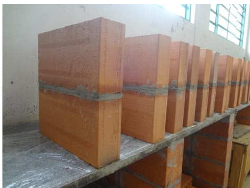
Figura 3-32: Prismas de blocos cerâmicos.
