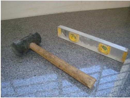
Figura 3-26: Martelo de borracha e nível de bolha.
