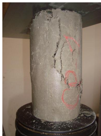
Figura 3-22: Corpo de prova de graute. Figura 3-23: Compressão de graute.
