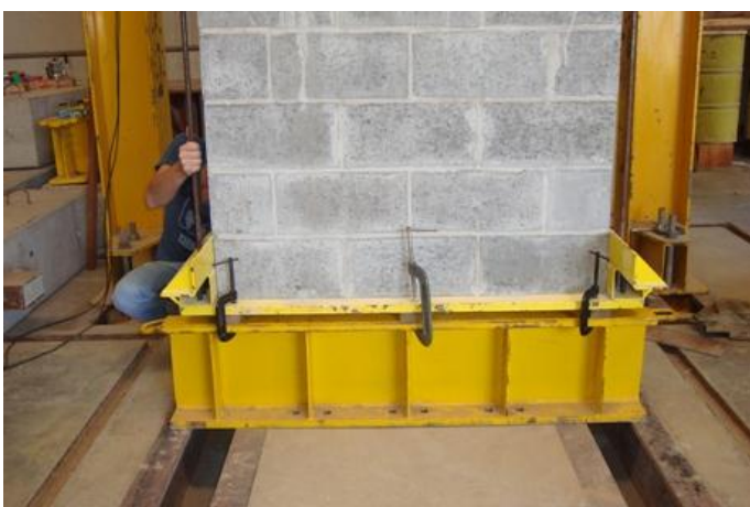
Figura 3-77: Fixação da viga inferior.
