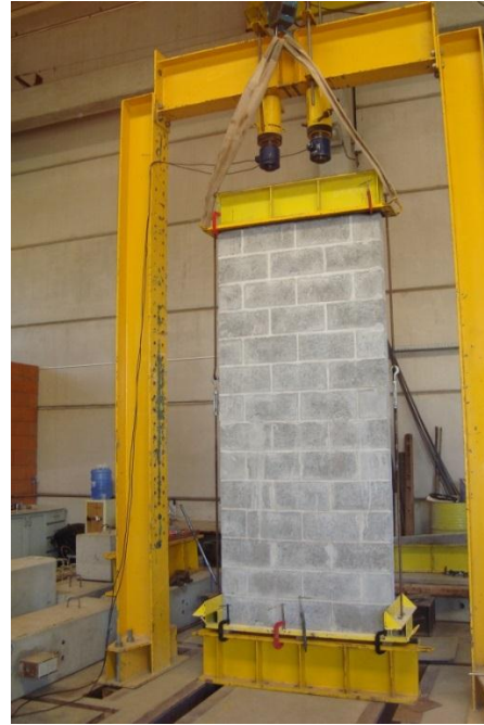
Figura 3-80: Paredre posicionada no pórtico de reação.
