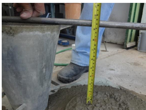
Figura 3-20: Medição do slump.
