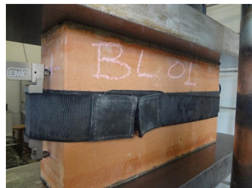
Figura 3-31: Ensaio de módulo de bloco cerâmico.
