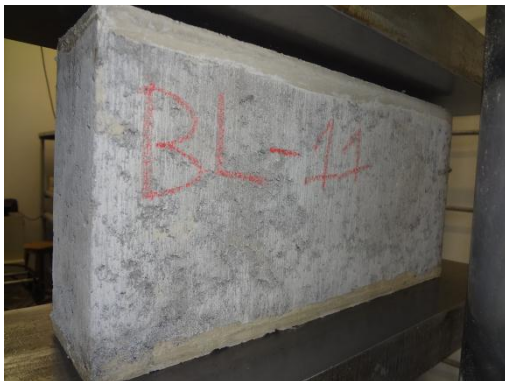
Figura 3-28: Ensaio a compressão de bloco de concreto.
