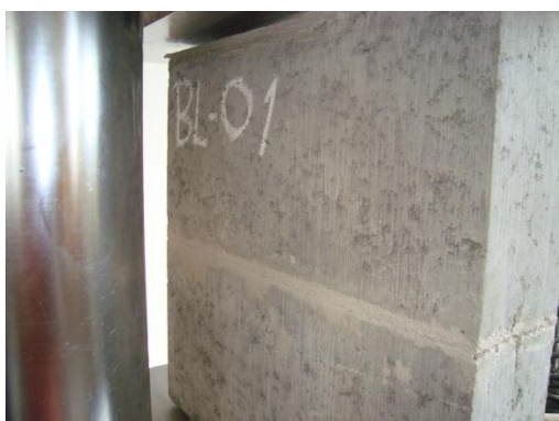
Figura 3-36: Ensaio a compressão de prismas de concreto.
