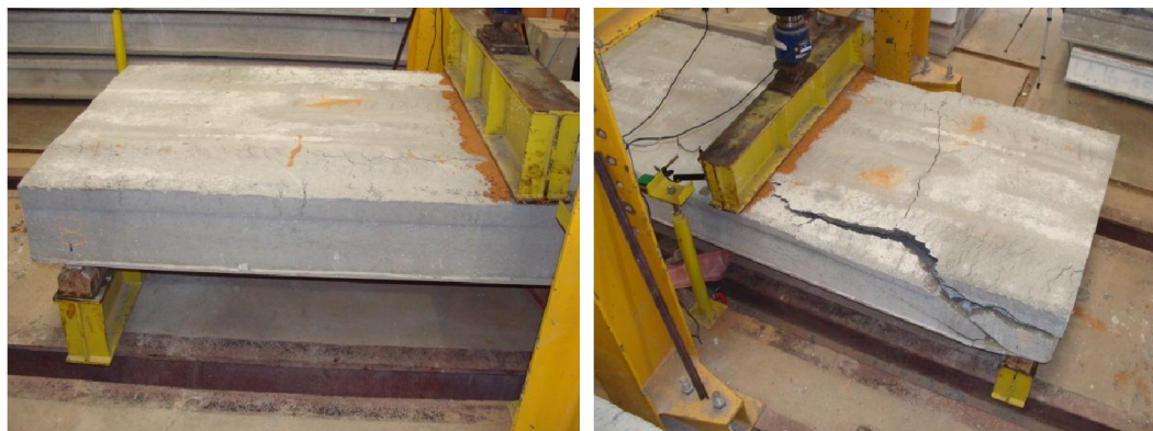
Figura 7.14: Laje LA03-C-B-b e sua ruptura
