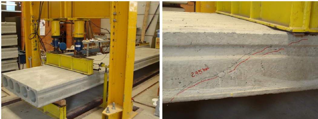
Figura 7.5: Laje LA06 e sua ruptura
