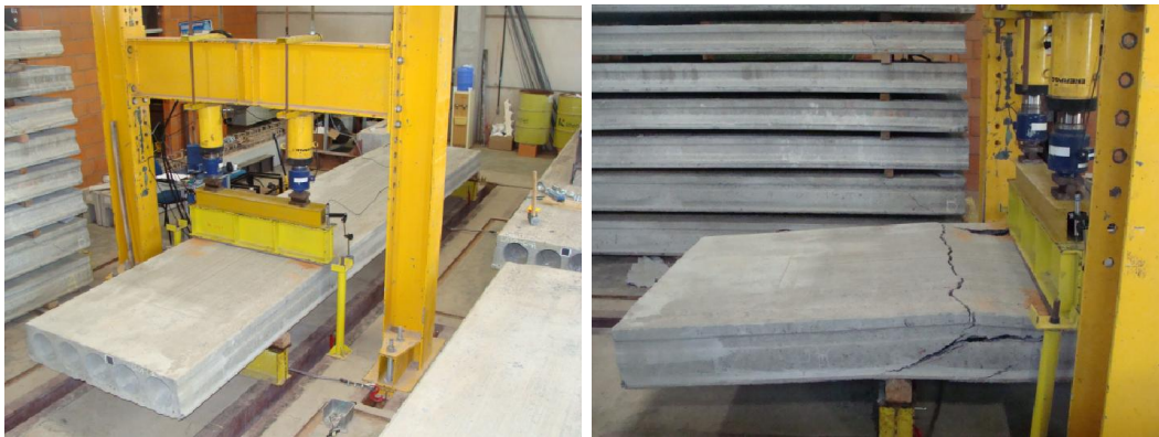
Figura 7.6: Laje LA09 e sua ruptura
