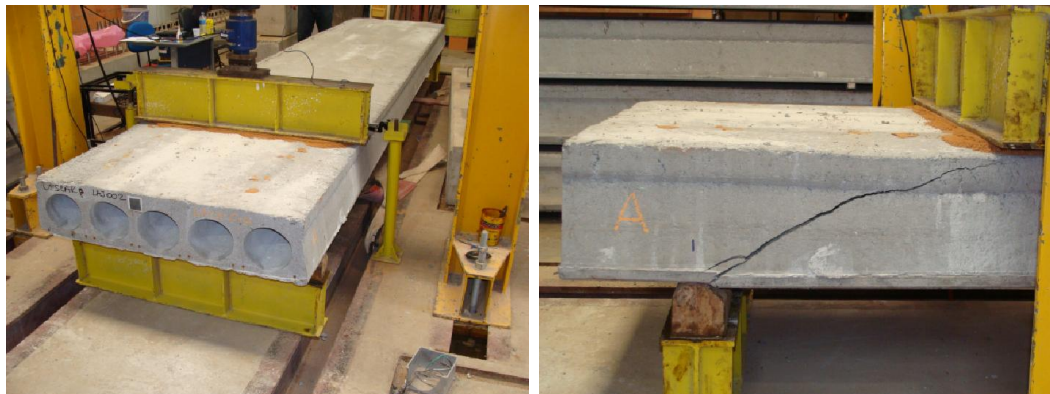
Figura 7.13: Laje LA03-C-B-a e sua ruptura
