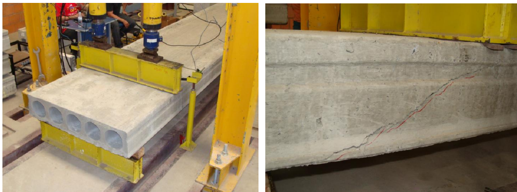
Figura 7.4: Laje LA04 e sua ruptura
