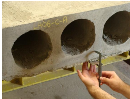
Figura 6.1: Medição realizada com paquímetro na seção transversal da laje
