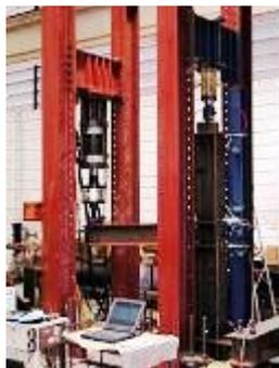
c) Ligação em “T” com chapa de topo em aço
