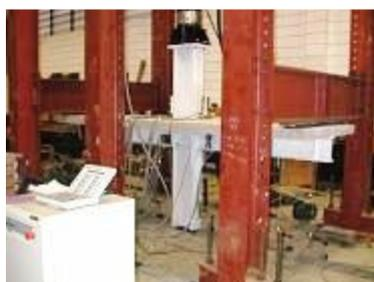
**a) Ligação cruciforme com chapa de topo em aço**
