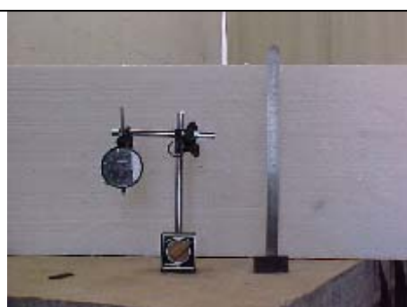
Fotografia 4.17. Defletômetro e régua metálica graduada
