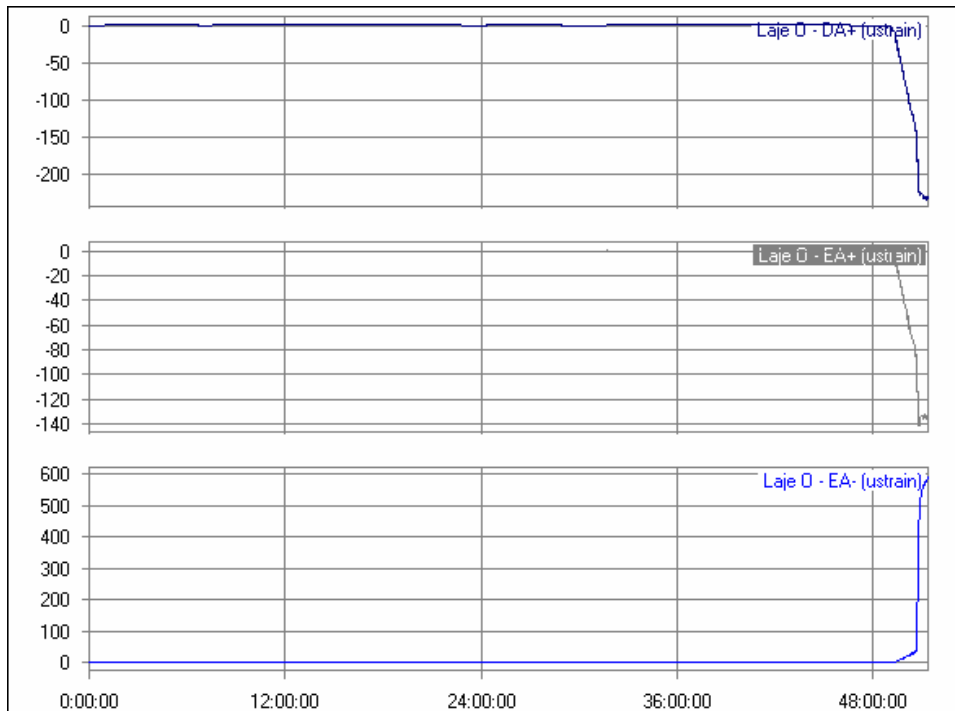
Gráfico 5.21. Deformações específicas nas primeiras 50 horas para laje O contínua (momento negativo-apoio central)
