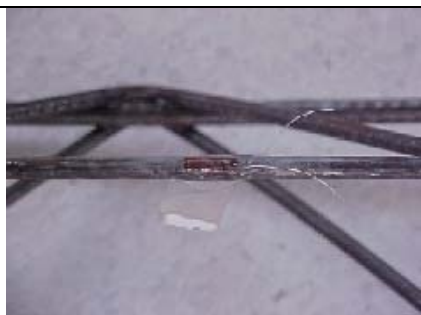
Fotografia 4.18. Fixação dos extensômetros elétricos
