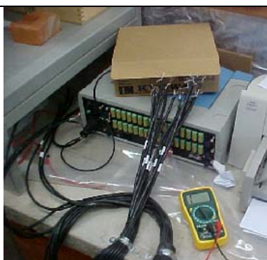
Fotografia 4.20. Sistema de aquisição de dados, cabos e multímetro
