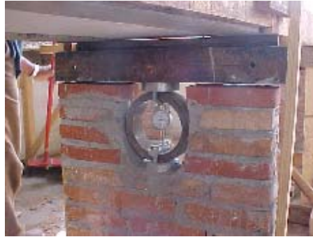
Fotografia 5.13. Dinamômetro fixado na alvenaria central da laje K – leitura da reação de apoio
