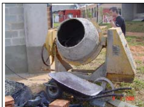
Fotografia 5.4. Betoneira usada para misturar o concreto
