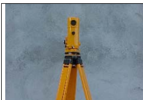
Fotografia 4.16. Nível de precisão topográfico com tripé de sustentação
