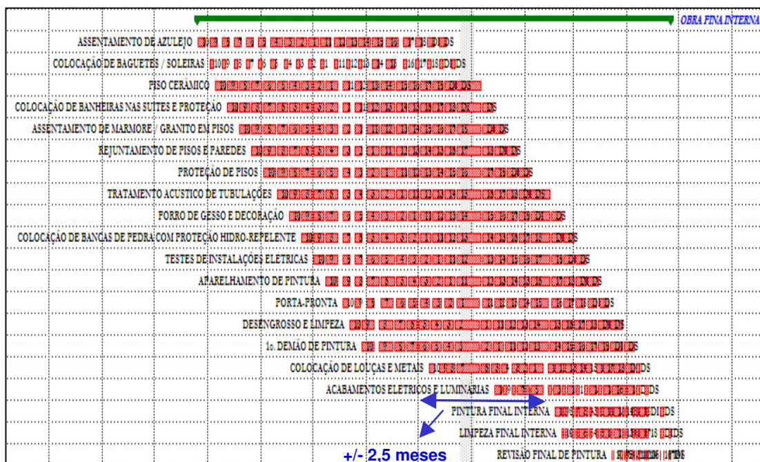
FIGURA 21: PARTE DO CRONOGRAMA FÍSICO DE EDIFÍCIO EM SISTEMA CONSTRUTIVO TRADICIONAL, COM INVERSÃO PARCIAL DOS SERVIÇOS E PROGRAMAÇÃO “ALAP”.
