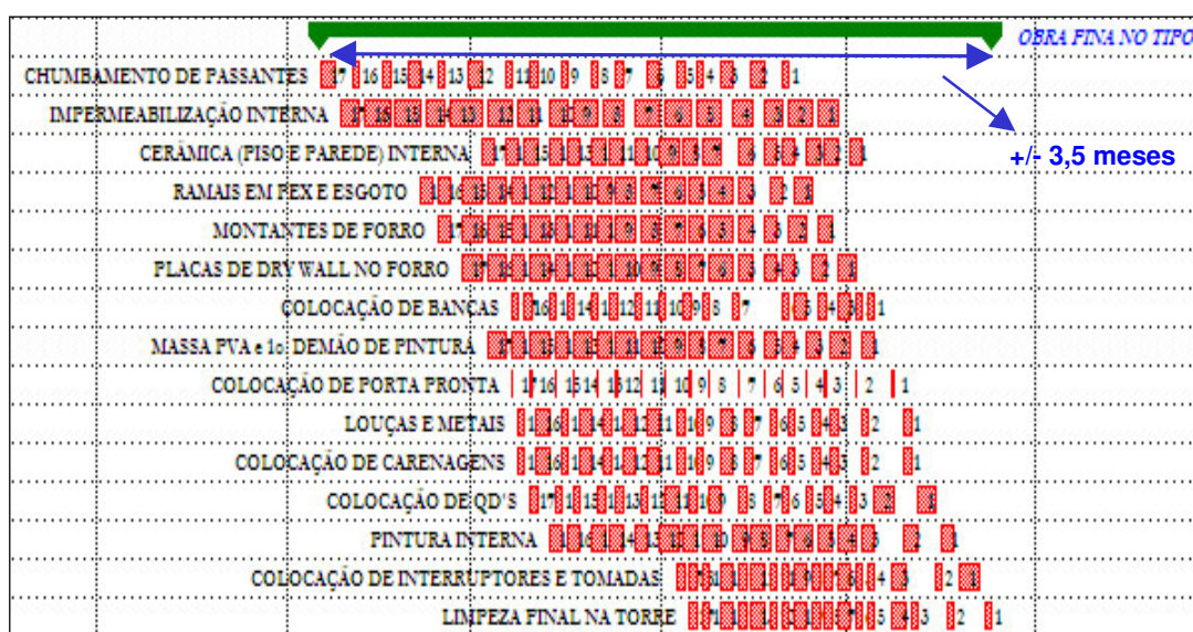
FIGURA 27: PARTE DO CRONOGRAMA FÍSICO DE EDIFÍCIO COM PAREDES EXTERNAS EXECUTADAS EM CONCRETO ARMADO MOLDADO "IN LOCO", COM INVERSÃO TOTAL DOS SERVIÇOS E PROGRAMAÇÃO “ALAP”.
