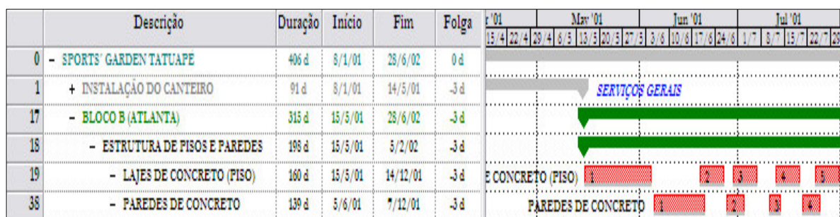
FIGURA 12: PARTE DO CRONOGRAMA FÍSICO DE EXECUÇÃO DA ESTRUTURA, COM A UTILIZAÇÃO DE PAREDES EXTERNAS EM CONCRETO ARMADO MOLDADO “IN LOCO”.
