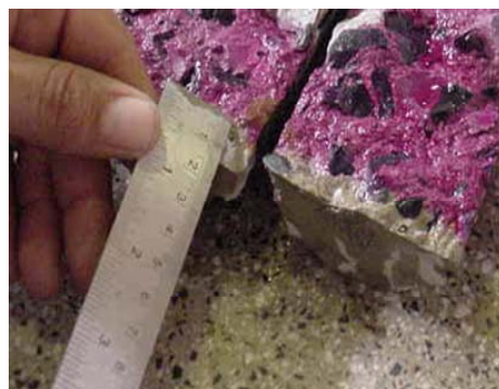
Figura 4.6 Medida da espessura carbonatada
