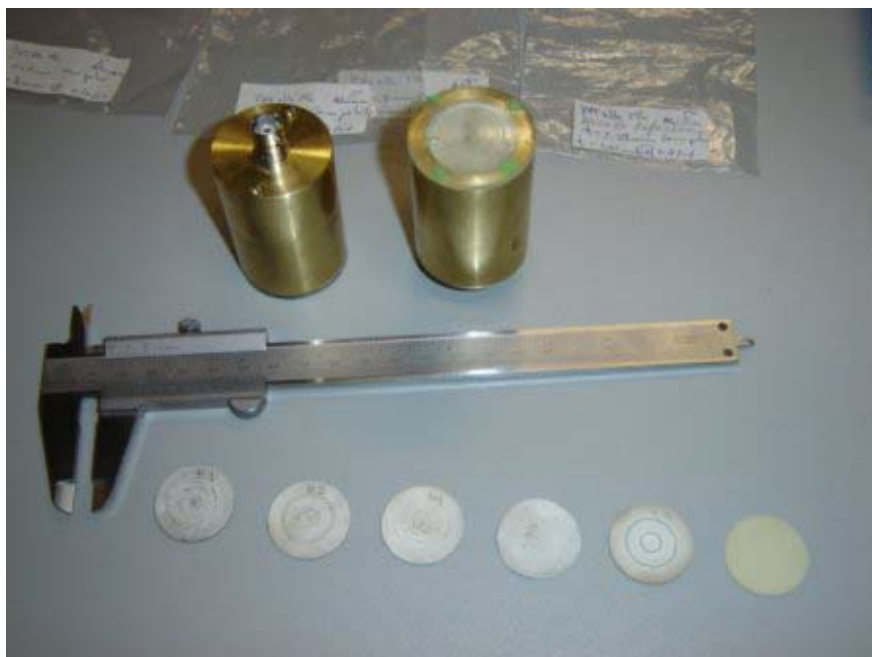
Figura 4.2- 3 Etapas da fabricação do Transdutor Bessel: a partir de uma cerâmica piezoelétrica convencional, os eletrodos se conformaram em forma de anéis concêntricos com pintura de prata. Logo depois de colocado o “backing” e o “matching” a cerâmica foi encapsulada.
