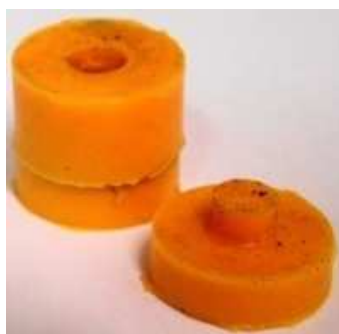
Figura 34: Pastilhador de silicone utilizado para prensar isostaticamente as amostras pó.
