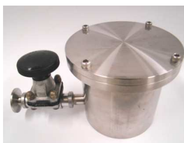
Figura 37: Recipiente com baixa pressão, 10^{-1} bar utilizado para guardar amostras de poli(3-hexiltiofeno).
