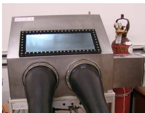
Figura 33: Caixa seca saturada com argônio utilizada na polimerização das amostras de poli(3-hexiltiofeno).
