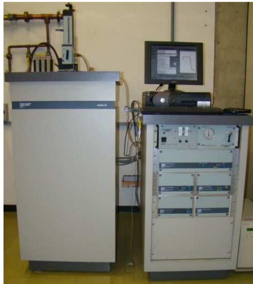
Figura 40: Magnetômetro SQUID completo, incluindo gabinete do dewar , dewar , controlador geral, fonte do magneto supercondutor, controlador de temperatura, unidade de potência, unidade de controle de fluxo de gás do magneto, microcomputador e monitor.
